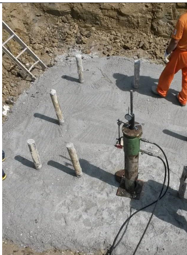
Figura 27 - Realizzazione di micropali tipo tubfix per un sostegno a traliccio; si possono osservare i 9 micropali già realizzati ed iniettati; in questa fase, prima dell'armatura e casseratura del plinto di fondazione, si sta eseguendo una prova di tenuta del micropalo allo strappamento, al fine di verificare la corretta progettazione e realizzazione dello stesso
