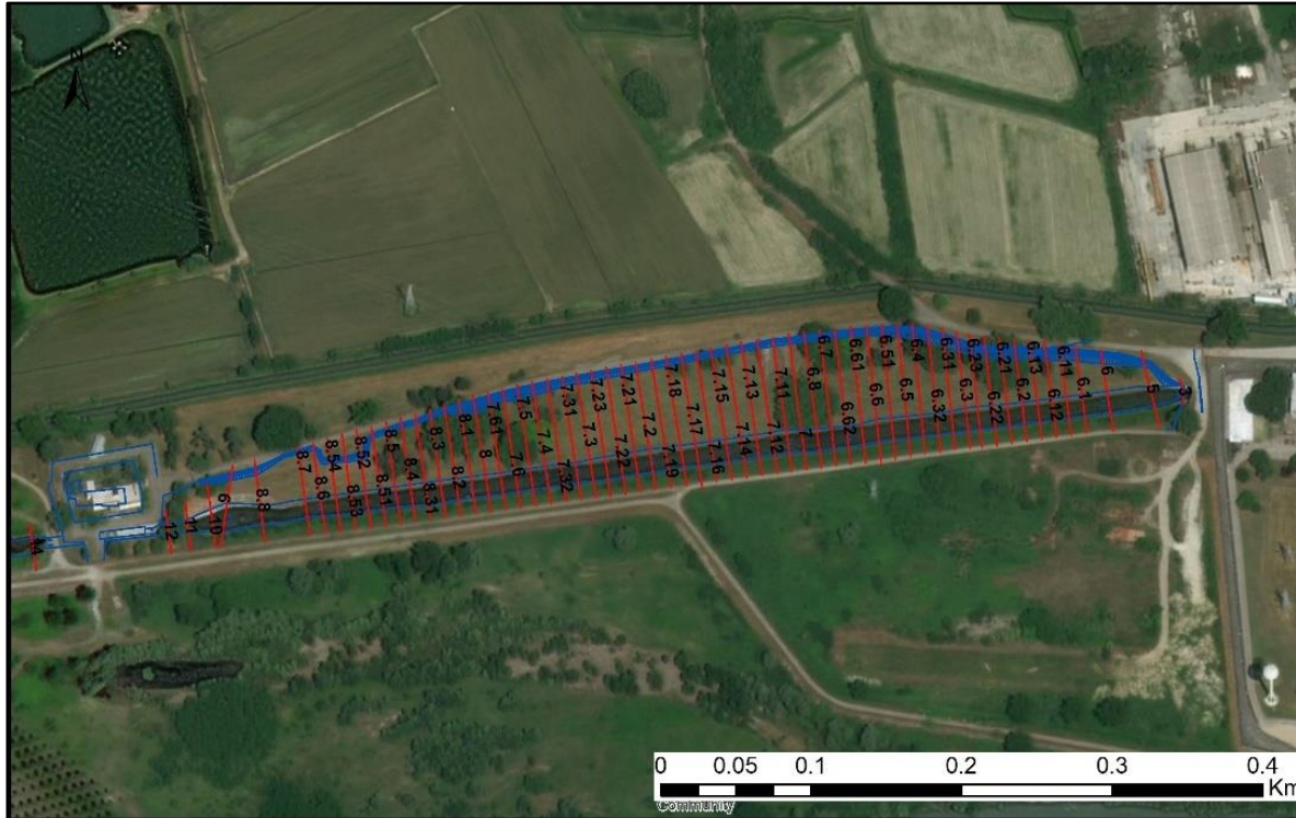
Figura 7 Rappresentazione in piano delle tracce delle sezioni d'alveo utilizzate nell'applicazione del modello per l'analisi idraulica dello stato ante operam. L'immagine riporta solo il tratto di Roggione che verrà interessato dagli interventi di ripristino.
