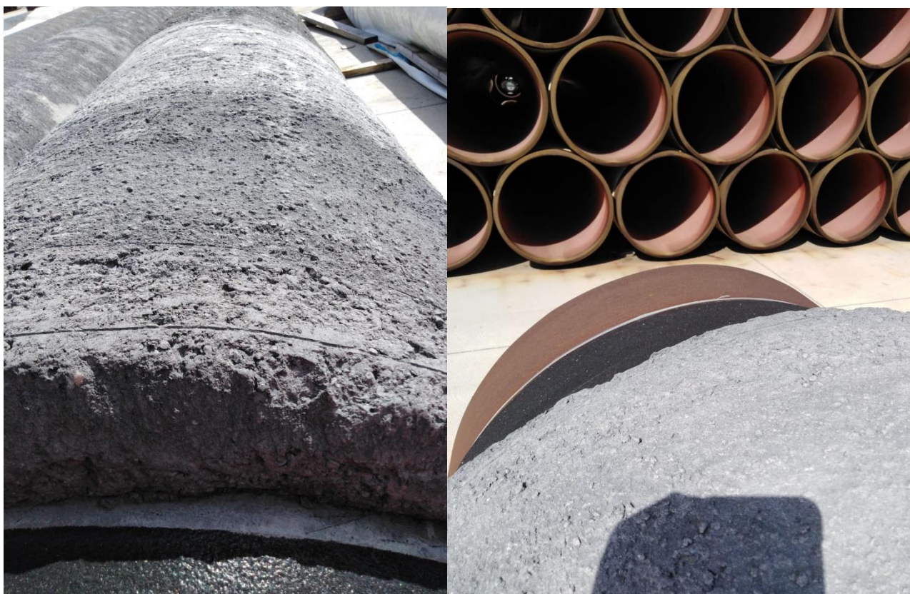
Figura 6.1: Strato di gunite (calcestruzzo) di cui sono rivestiti i singoli tubi del gasdotto
