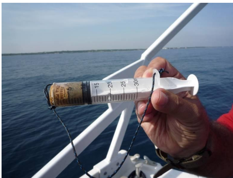
Figura 3-14: La siringa tagliata utilizzata per il prelievo del sedimento in immersione per la raccolta del microfitobenthos sui fondi mobili
