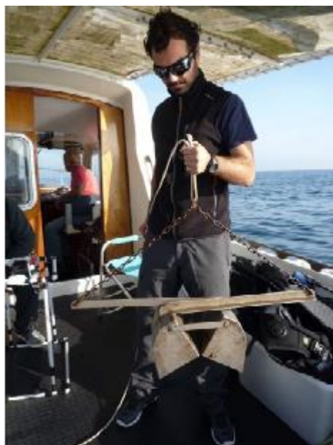
Figura 2.4 La preparazione della benna Van Veen per il campionamento sui fondi mobili
