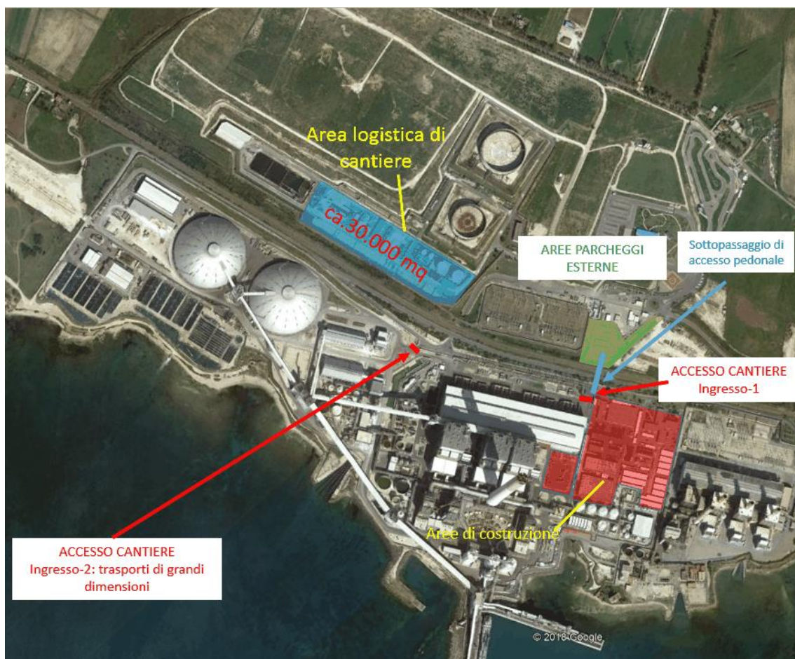
Figura 4.3.11 – Aree di cantiere con evidenza degli accessi e dell'area di realizzazione delle opere
