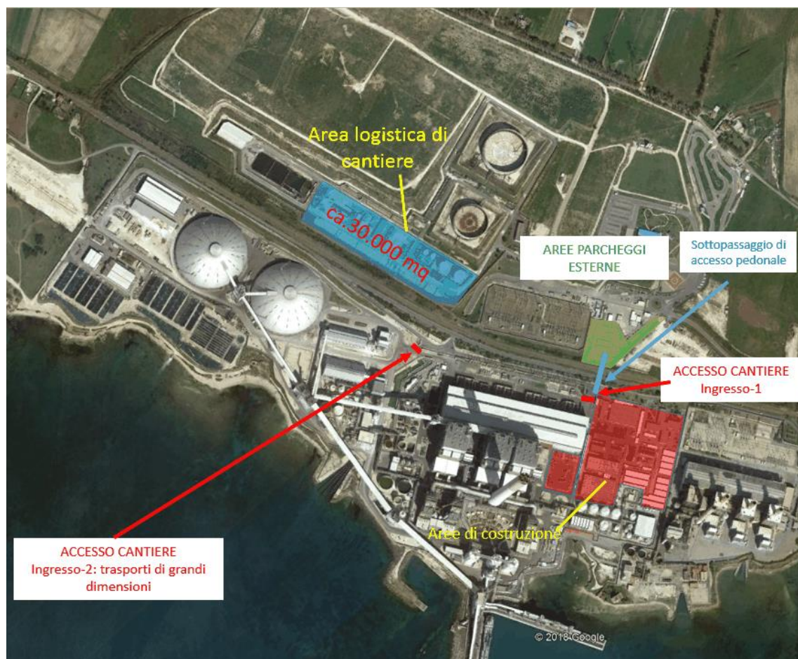
Figura 3.4.3 – Accessi all'area di cantiere
