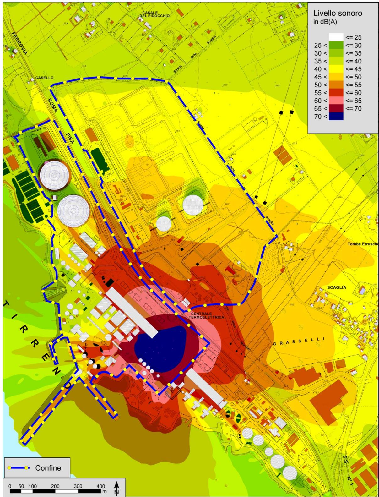
Figura 12 – C.le di Torrevaldaliga - -Cantiere per la realizzazione della nuova unità TN1 - Curve isofoniche di immissione specifica nell'area circostante all'altezza di 4 m dal suolo per la fase di preparazione del sito e scavo.
