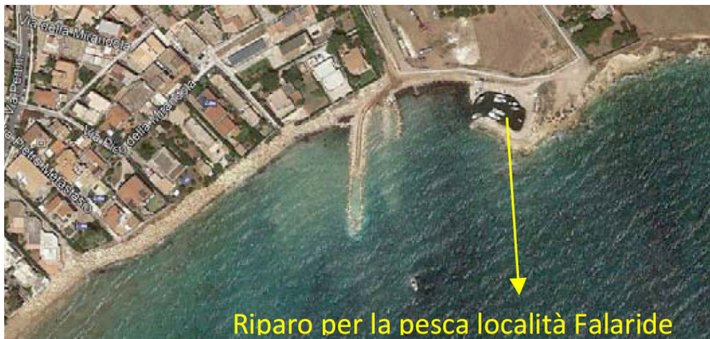
Fig. 1 Opere di difesa costiera già eseguite (massciata e pennello) e sbocco del torrente Cava l'Unica (tra il pennello e il riparo per la pesca).
