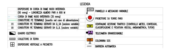
Figura: Schema tipico impianto di terra a servizio degli impianti esterni
