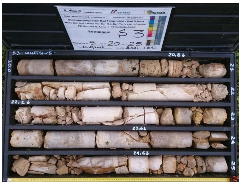
Sondaggio S3: Cassetta n. 5 da 20.0 a 25.0 m
