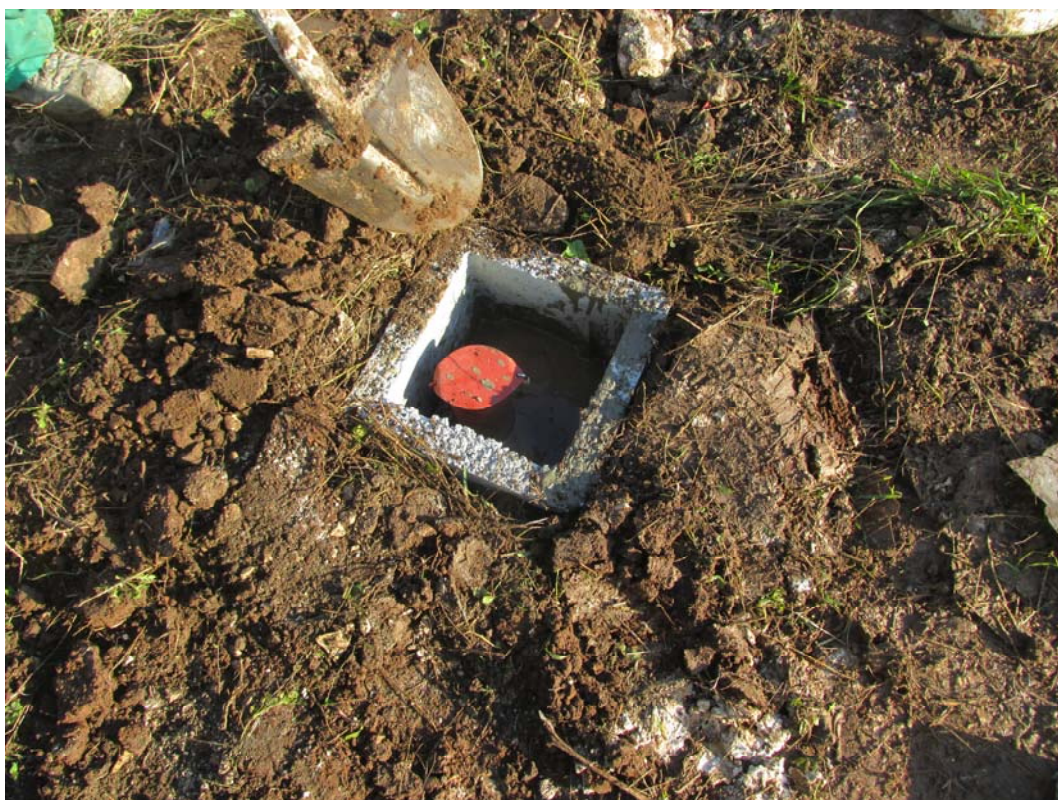
Sondaggio S1: Pozzetti di protezione piezometro
