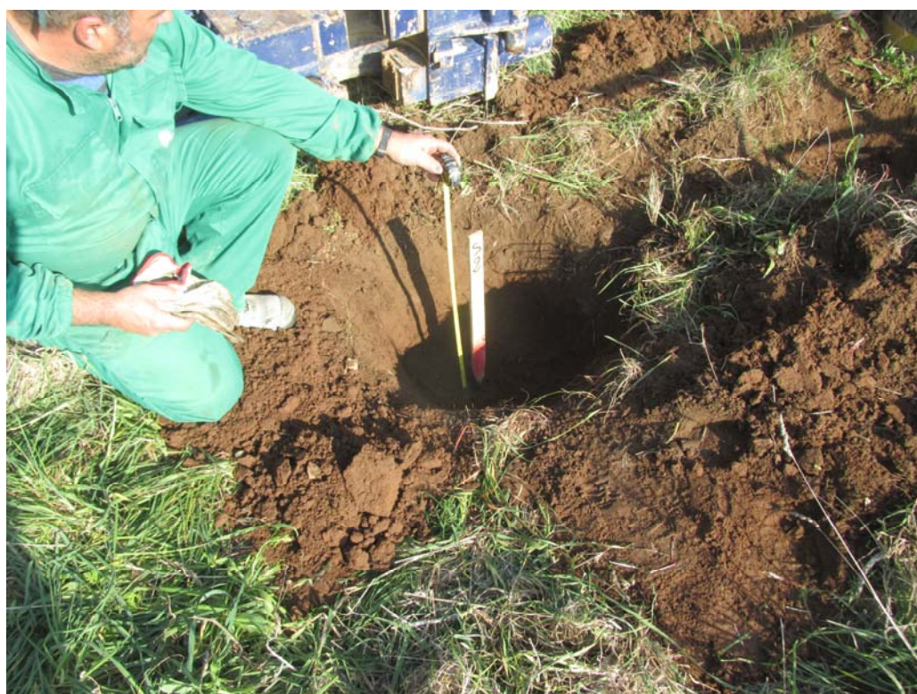
Sondaggio S2: Pre-scavo eseguito a mano
