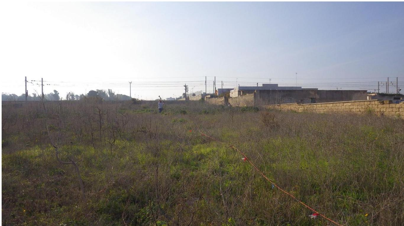
Stendimento sismico per registrazione Re.Mi. / MASW
