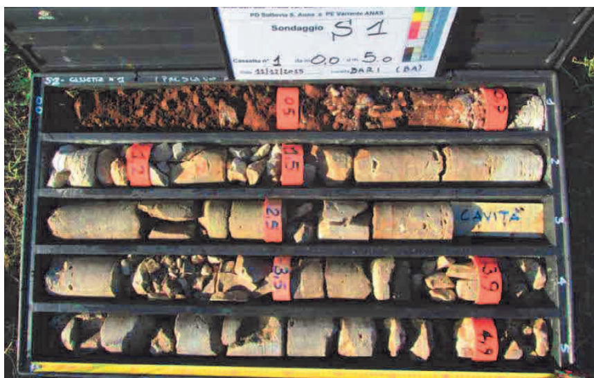
Figura 7 –sondaggio S1 (da 0.0 a 5.0 m da p.c.)
