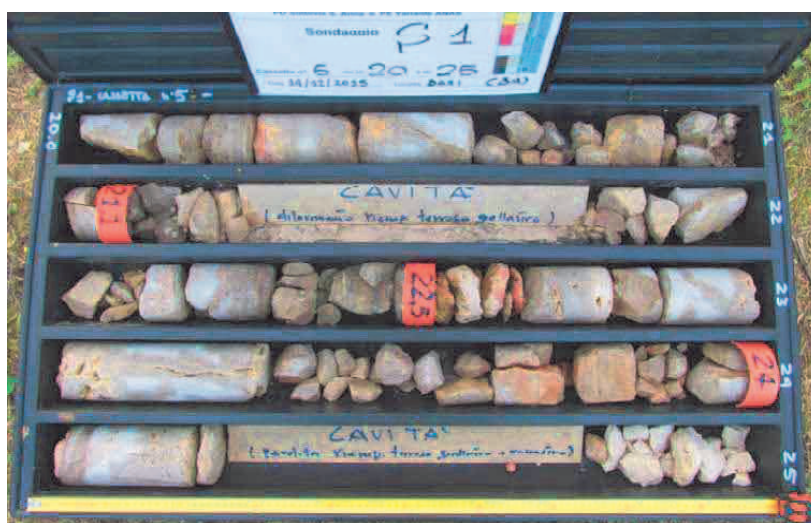
Figura 8 –sondaggio S1 (da 20.0 a 25.0 m da p.c.)
