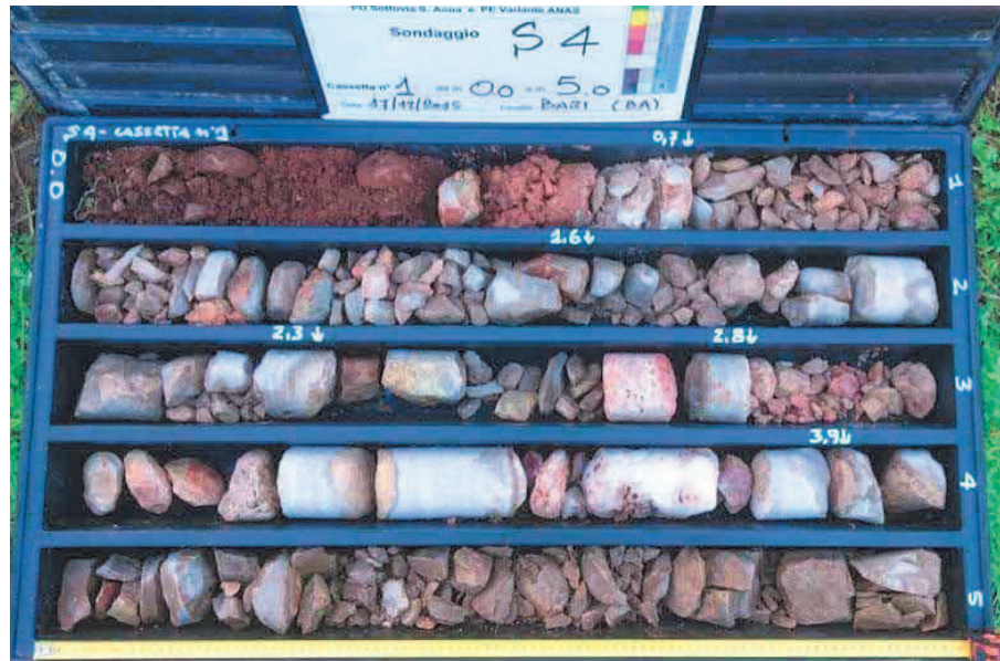
Figura 11 –sondaggio S4 (da 0.0 a 5.0 m)
