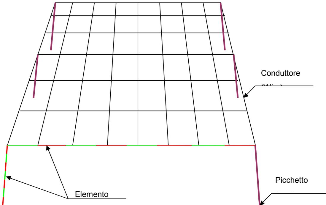
**Figura: Schematizzazione di un Elettrodo**
