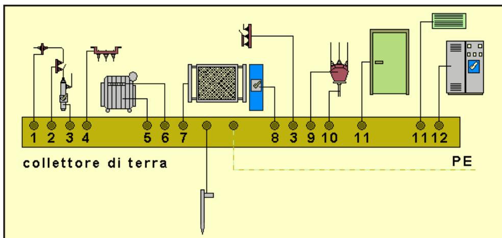
**Figura 9 – Esempi di collegamenti a terra in cabina**
