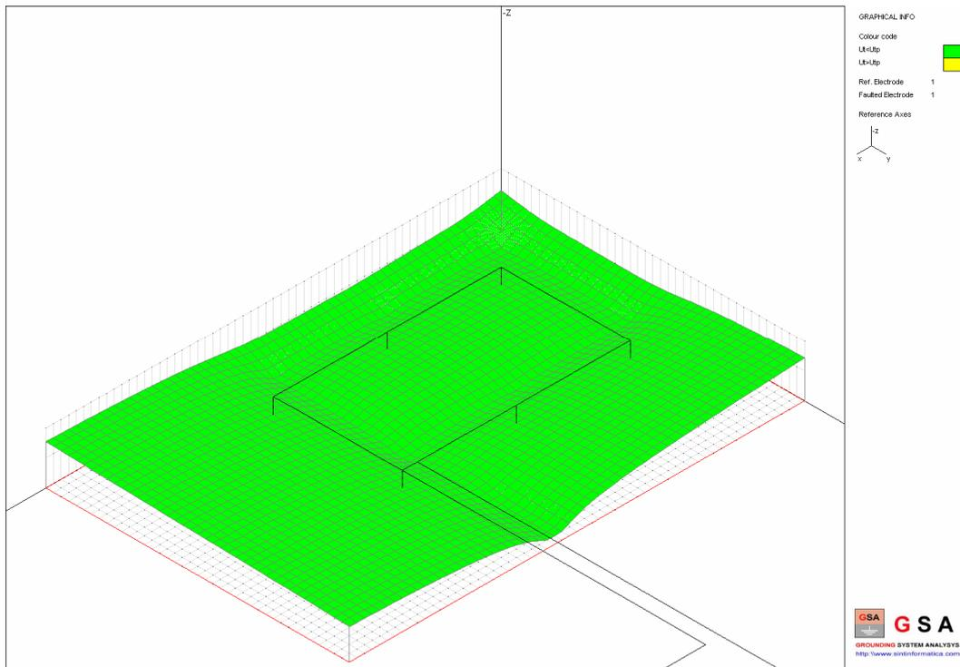
Figura 5 - Distribuzione delle tensioni di contatto e confronto con i limiti ammessi (rapp. 3D)
