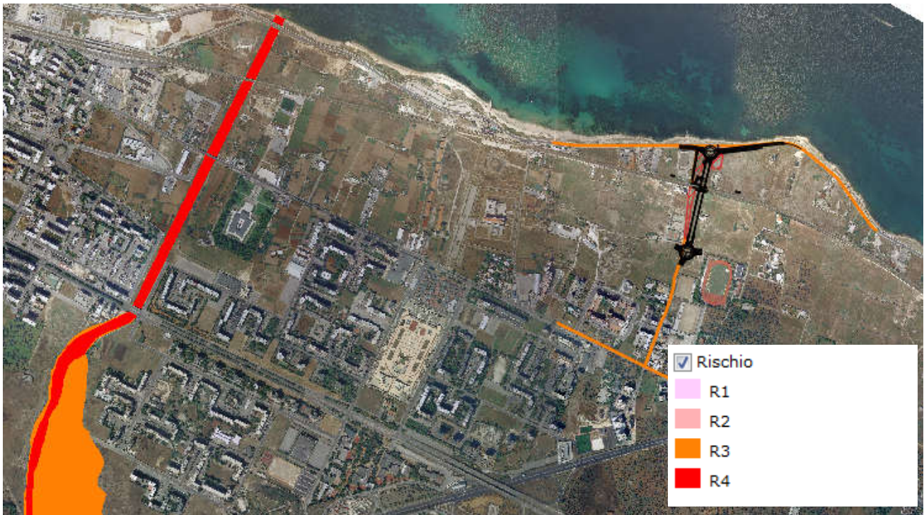
Figura 18. Aree a rischio idraulico con indicazione del progetto, aree di lavoro e aree di cantiere
