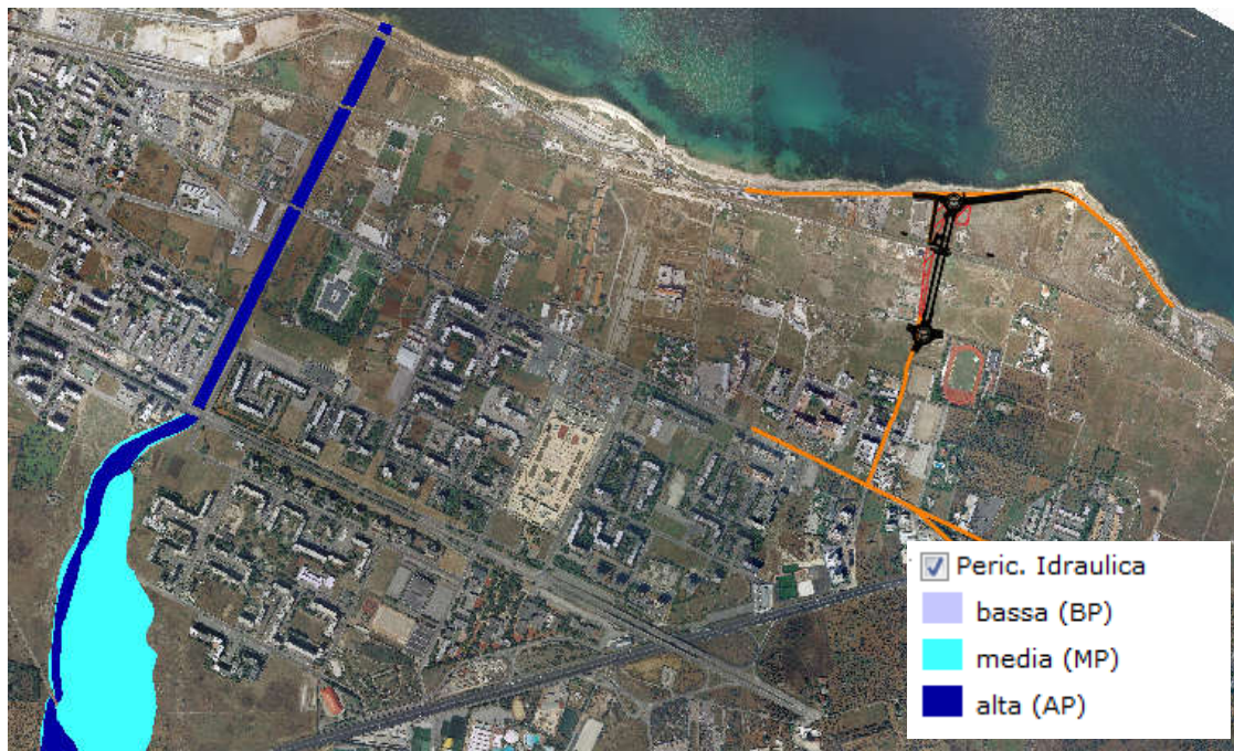
Figura 17. Aree di pericolosità idraulica con indicazione del progetto, aree di lavoro e aree di cantiere
