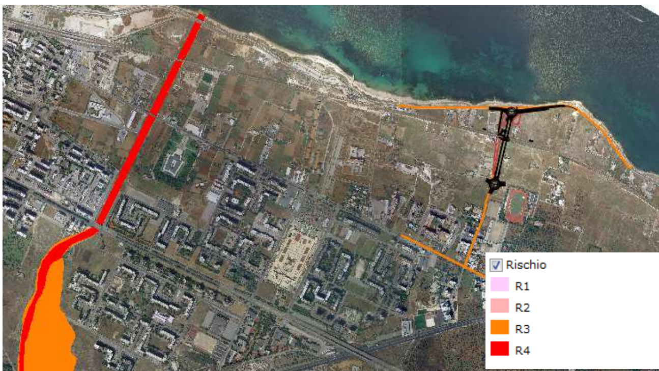
Figura 2-7: Aree a rischio idraulico con indicazione del progetto, aree di lavoro e aree di cantiere.
