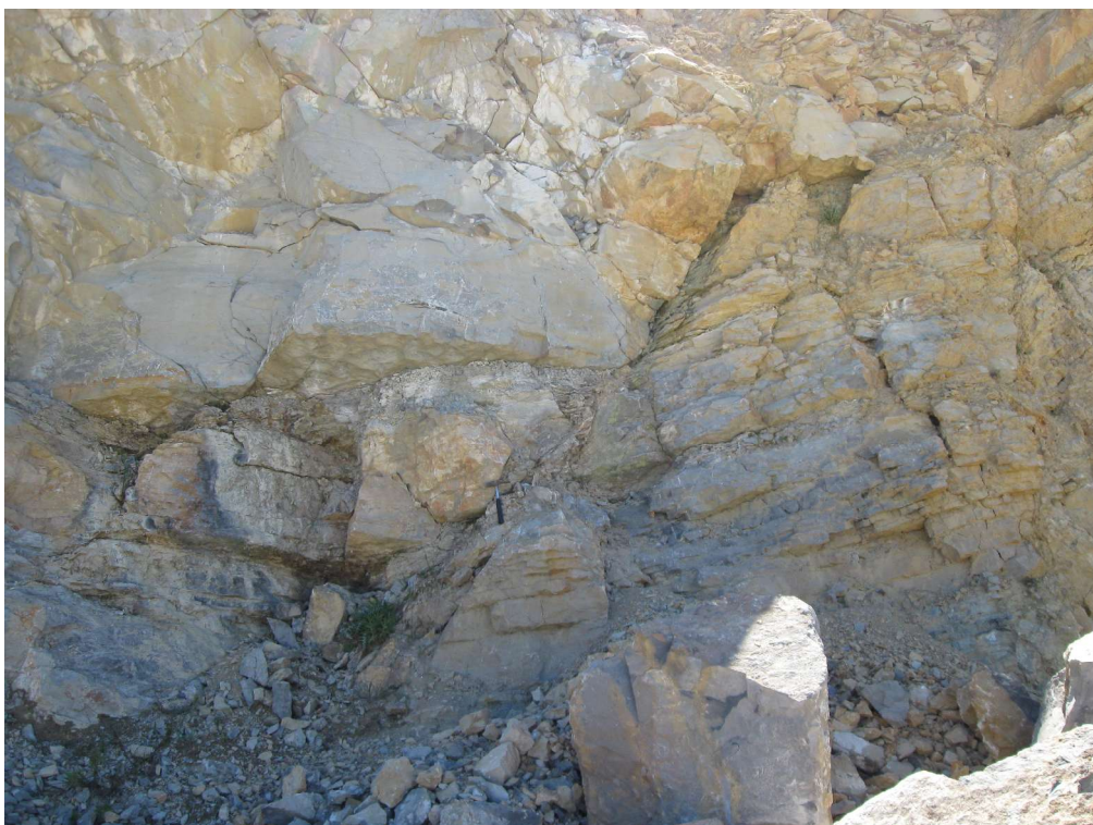
Fig. 3 - Area fortemente fratturata in corrispondenza della faglia con piano orientato N80/60 (Loc. Monte Rosè).
