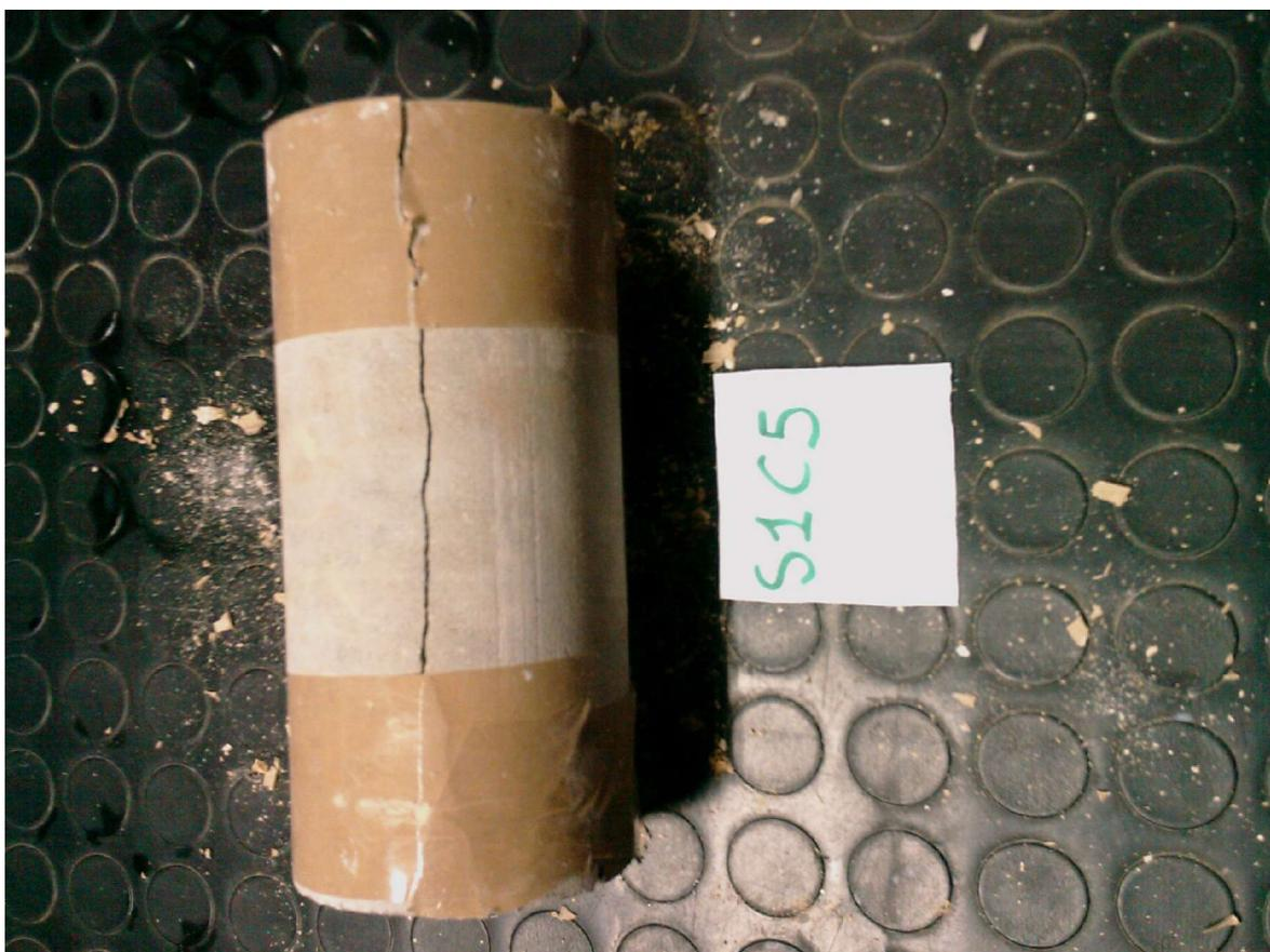
Foto n° 14 – Particolare prova di schiacciamento campione S1C5.
