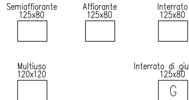
Pozzetto prefabbricato in cls (con tipologia e dimensioni)
