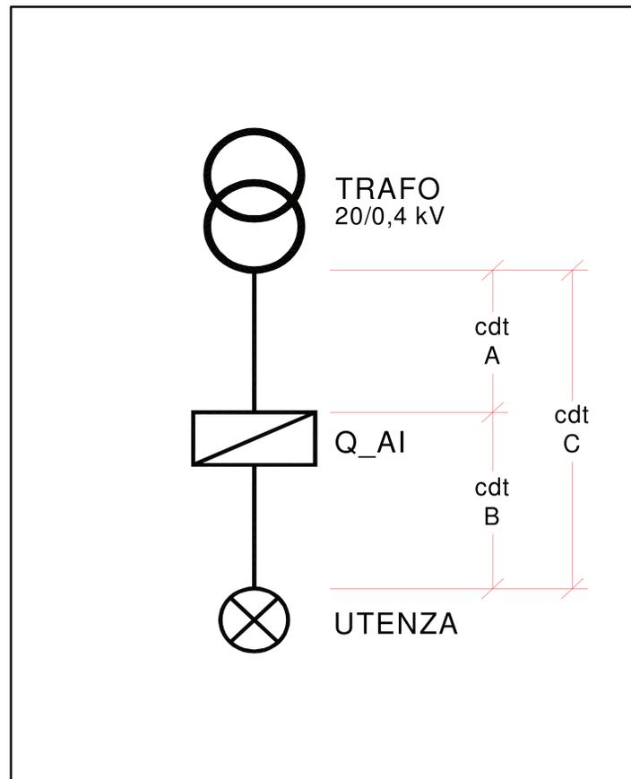
L'origine dell'impianto, caratterizzato da tale livello di tensione nominale, coincide pertanto con i morsetti secondari del trasformatore MT/BT.
