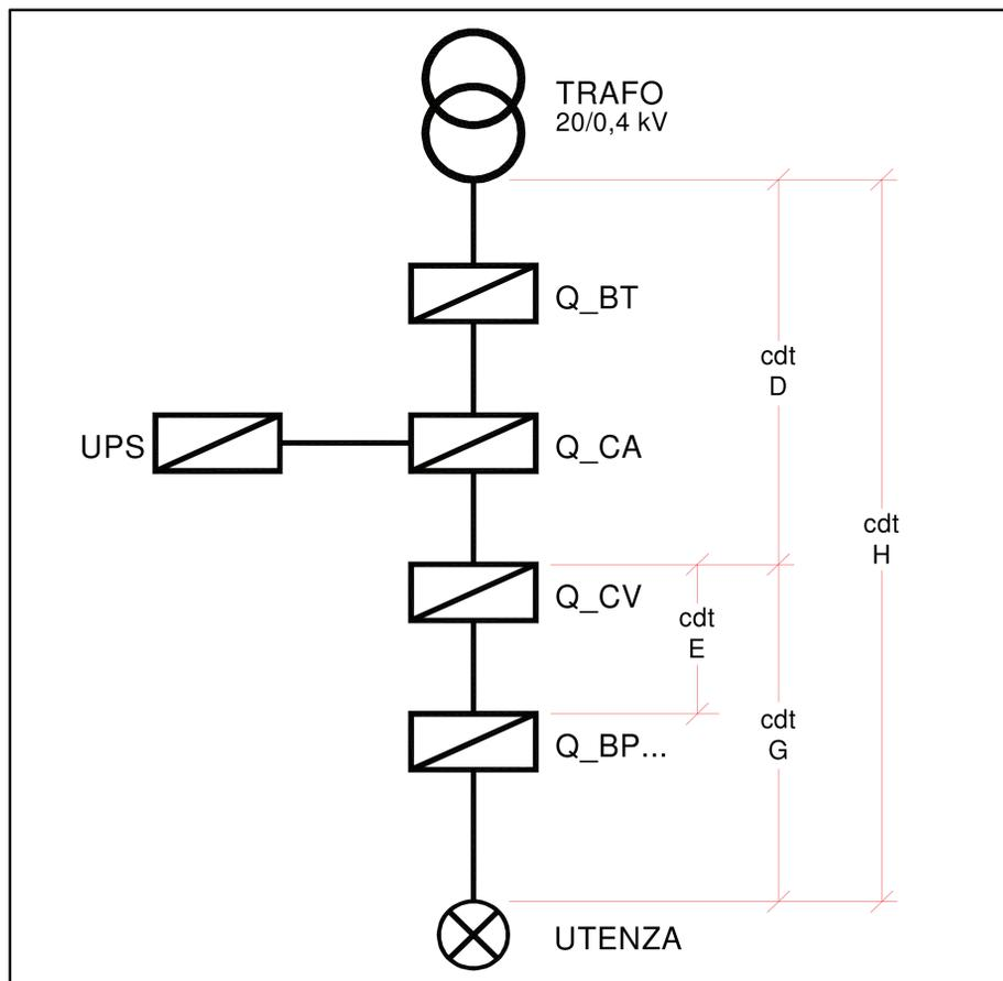
L'origine dell'impianto, caratterizzato da tale livello di tensione nominale, coincide pertanto con i morsetti secondari del trasformatore MT/BT.
