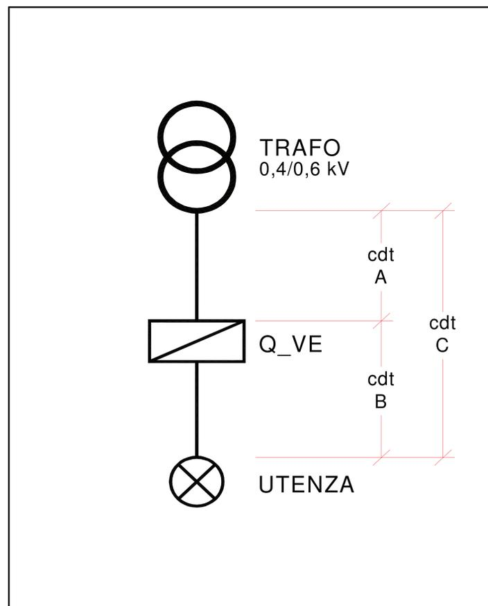
L'origine dell'impianto, caratterizzato da tale livello di tensione nominale, coincide quindi con i morsetti secondari del trasformatore BT/BT avente tensione nominale primaria 400V e tensione secondaria, a pieno carico, pari a 690V (tensione a vuoto pari a circa 718V).
