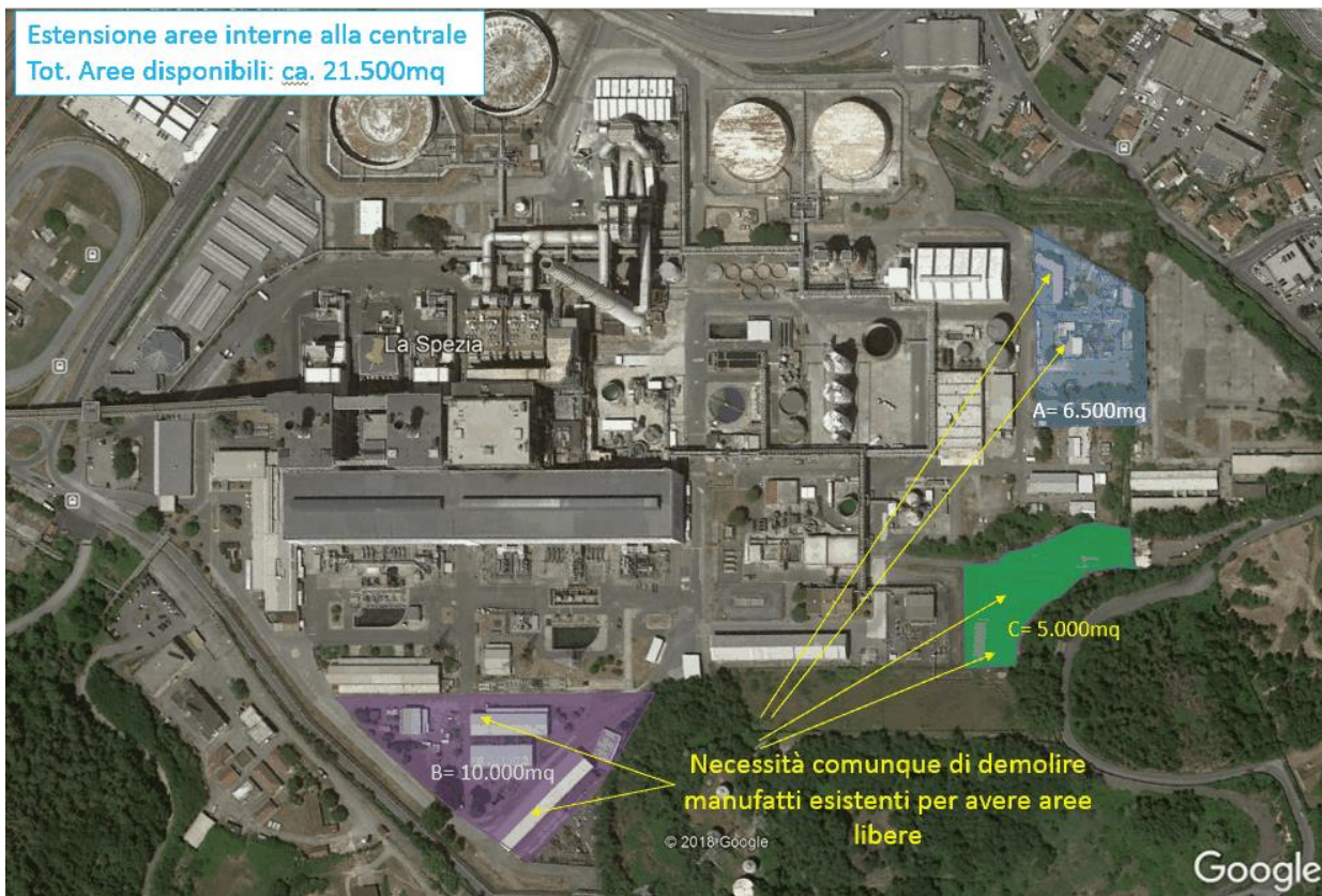
Figura 4.3.12: Individuazione delle aree di cantiere
