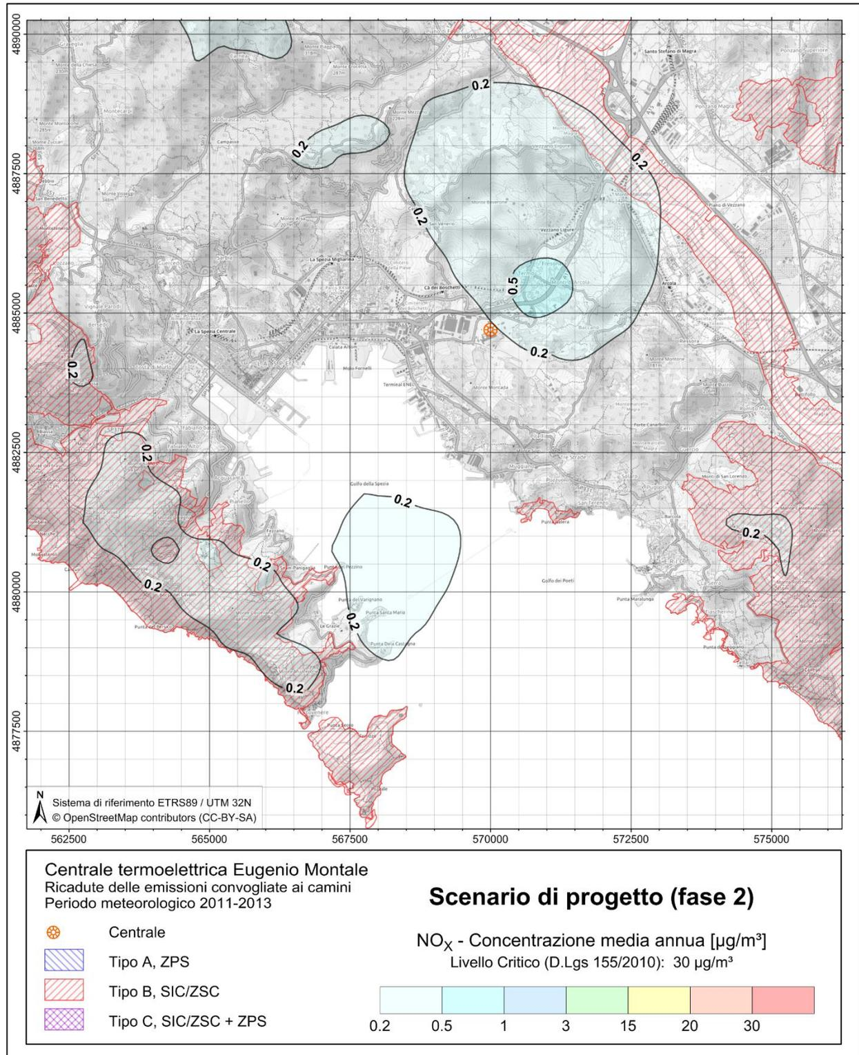
**Figura 7.2.4 – Ricadute delle emissioni convogliate ai camini NO<sub>x</sub> – scenario progetto (ciclo combinato)**
