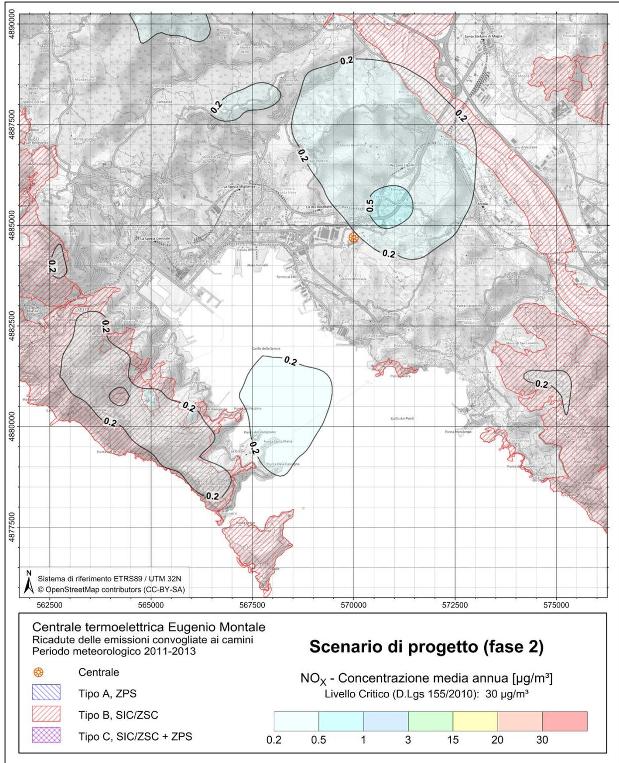
Figura 5.1.1 - Ricadute delle emissioni convogliate ai camini NO<sub>x</sub> – scenario di progetto
