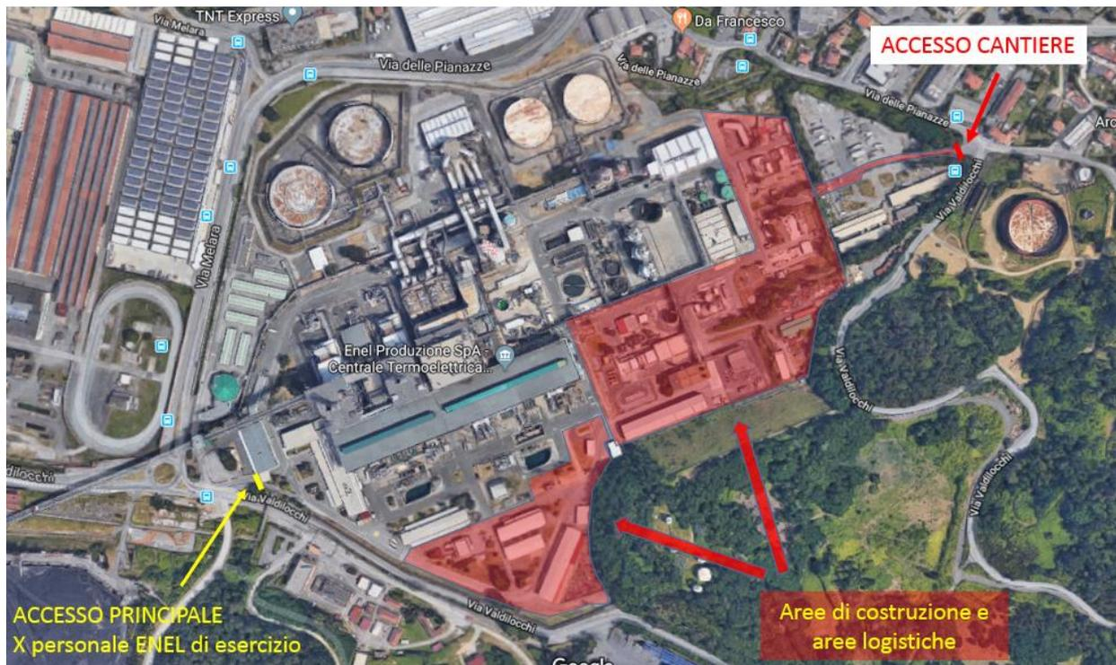
Figura 4.4.3 – posizione degli accessi alle aree di cantiere
