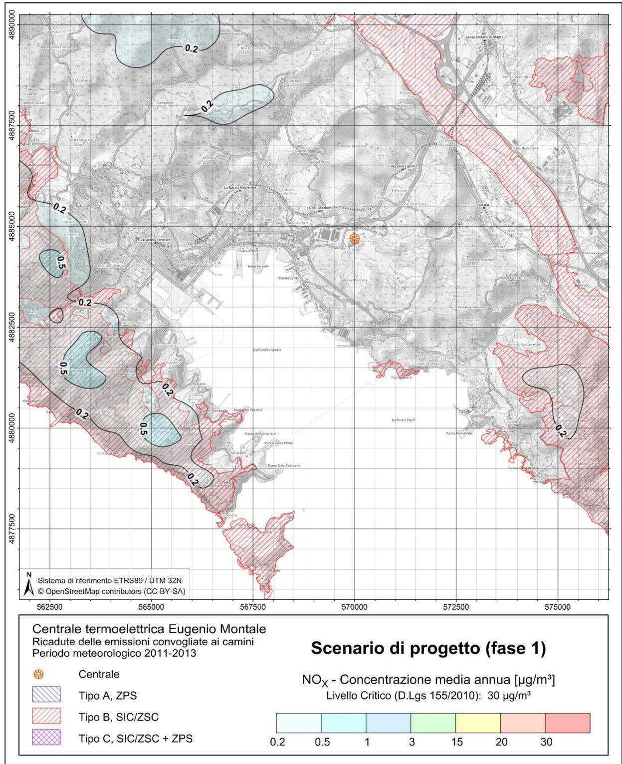
**Figura 7.2.3 – Ricadute delle emissioni convogliate ai camini NO<sub>x</sub> – scenario progetto (fase 1-ciclo aperto)**
