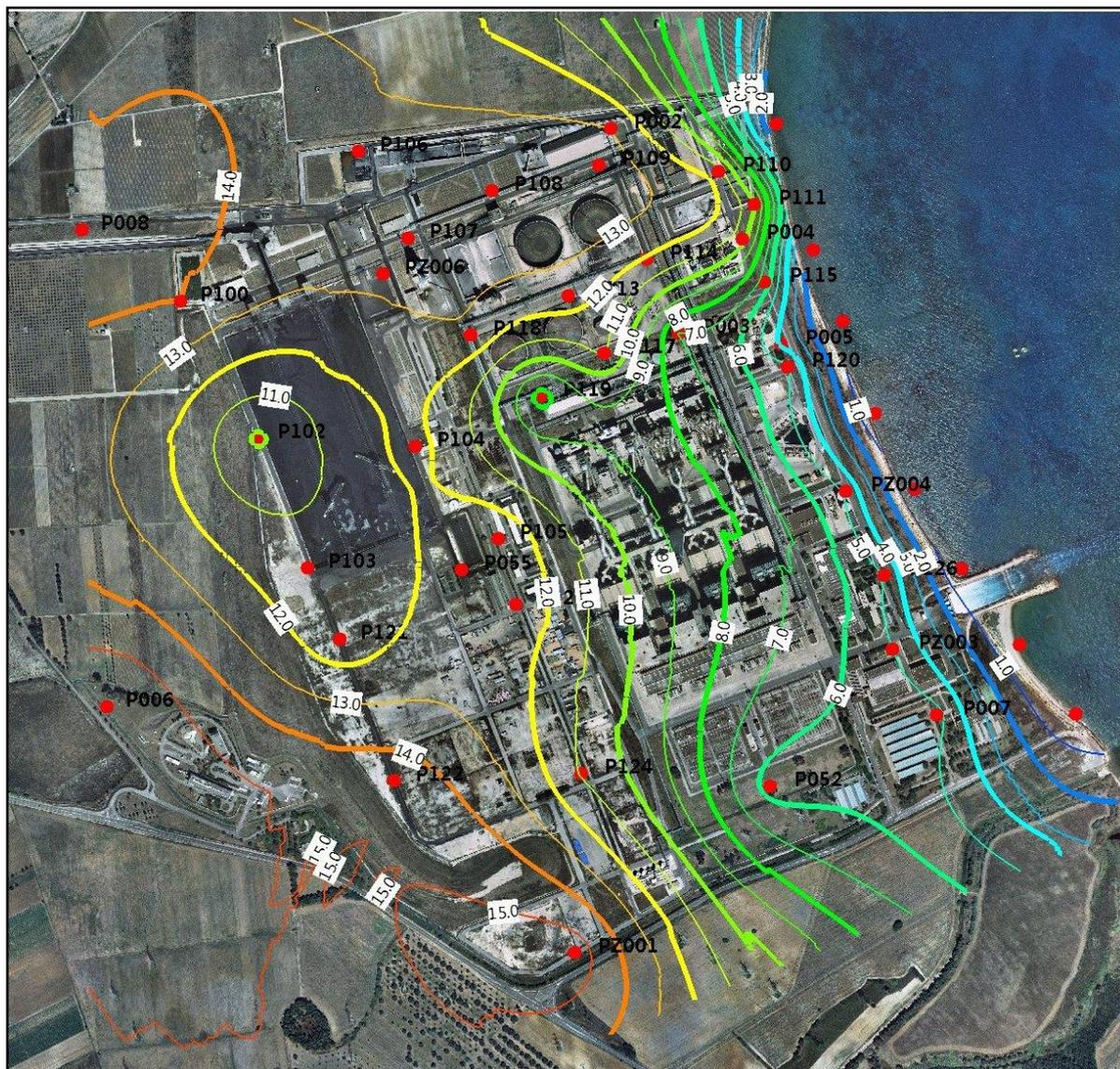
**Figura 4 – Ricostruzione dell'andamento della superficie piezometrica**
