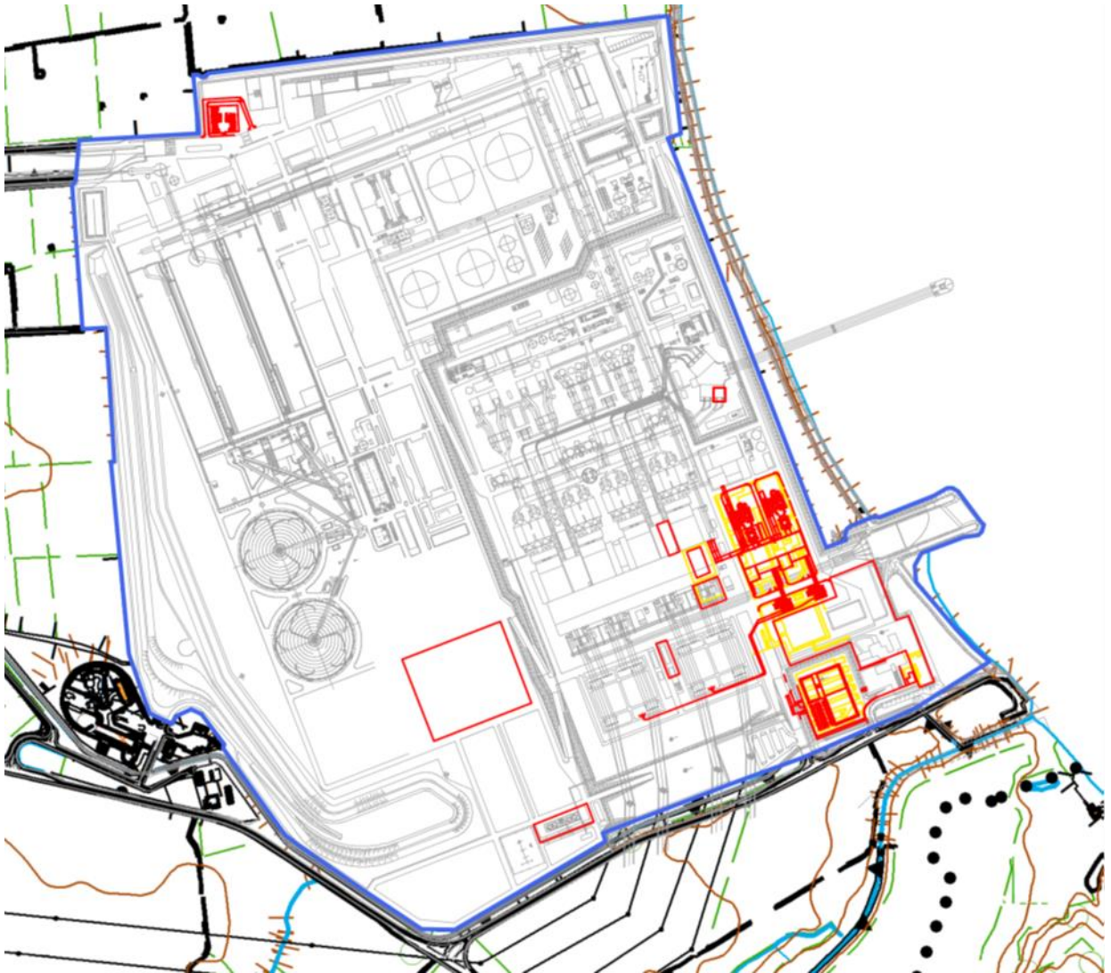
Figura 4.5.1. Superficie interessata dalla Centrale e dalla costruzione del nuovo ciclo combinato (in rosso le nuove parti d'impianto).
