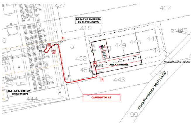
Fig. 1: Collegamento della stazione di utenza dell’impianto della società Breathe Energia in Movimento S.r.l. allo stallo AT della Stazione Terna Melfi 150/380 kV- Soluzione denominata “provvisoria”
