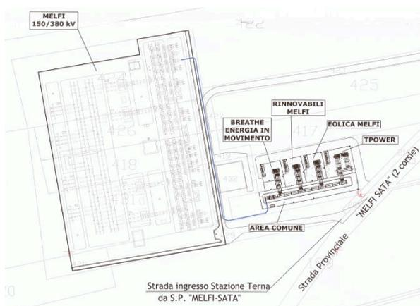
Fig. 3: Collegamento della stazione di utenza dell’impianto della società Breathe Energia in Movimento S.r.l. allo stallo AT della Stazione Terna Melfi 150/380 Kv- Soluzione denominata “definitiva” (proposta non più realizzata)
