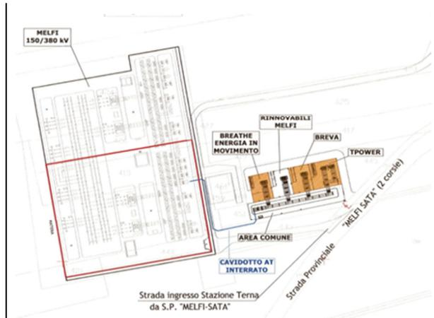
Fig. 2: Collegamento della stazione di utenza dell’impianto della società Rinnovabili Melfi. allo stallo AT della Stazione esistente Terna Melfi 150/380 kV (in rosso) - Soluzione denominata “provvisoria”
