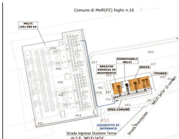
Fig. 4: Collegamento della stazione di utenza dell’impianto della società Rinnovabili Melfi. allo stallo AT della Stazione Terna Melfi 150/380 Kv- Soluzione denominata “definitiva” (proposta non più realizzata)
