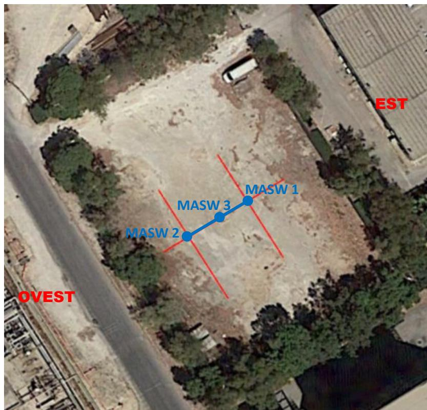
Figura 22 - In blu la sezione ricavata dall'elaborazione bidimensionale dei centri degli stendimenti eseguiti (pallini in blu)
