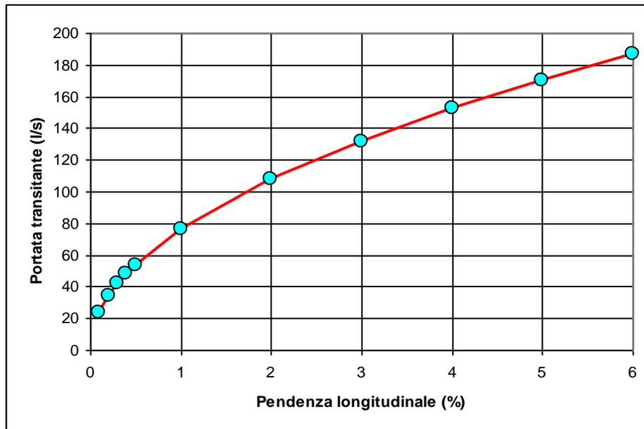
Figura 6.5 – Portata massima transigente per cunetta triangolare CT2 in funzione della pendenza longitudinale
