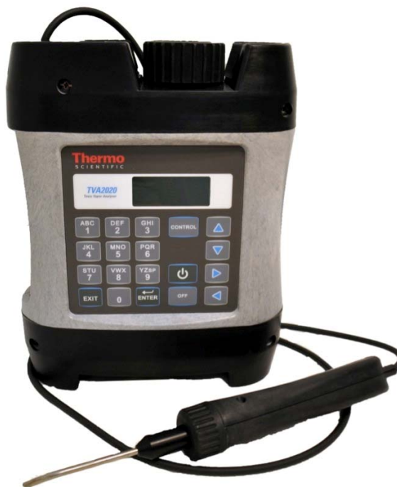
Figura 3B- 2 Analizzatore TVA 2020
