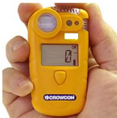
Figura 3-4 Esplosivimetro portatile Crowcon Gasman2
