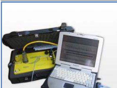
Sismografo compatto a 24 bit, numero di canali per modulo da 3 a 24, ampio range dinamico 144db, output dei dati in SEG-Y, SEG-2 o ASCII, possibilità di scaricare i dati in modalità wireless e opzione per test dei geofoni ed accelerometri. Lunghezza di registrazione : fino a 4 mld di campioni. Intervalli di campionamento: 0.0208, 0.0625, 0.125, 0.250, 0.500, 1.00, 2.00, 4.00, 8.00, 16.00 ms.
