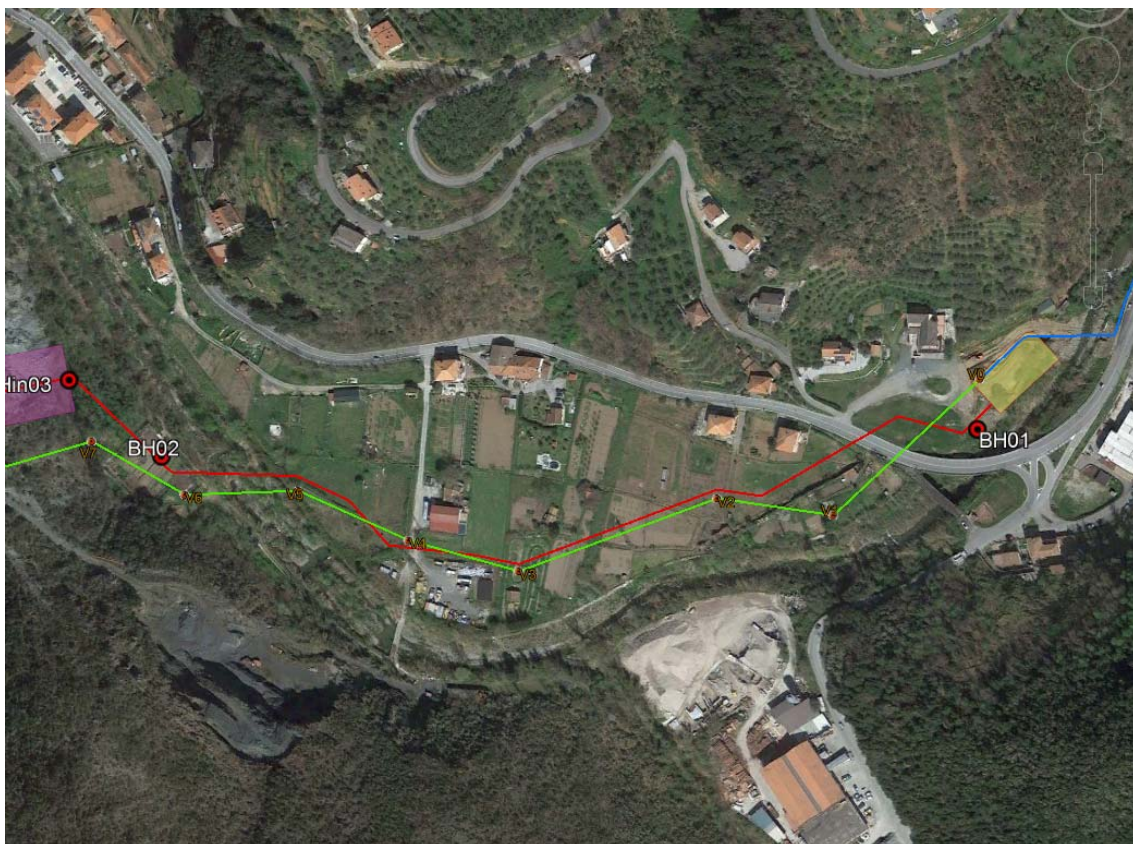
Fig. 4.5/A: Posizione dei sondaggi geognostici eseguiti in asse al tracciato del metanodotto in progetto, in corrispondenza dei siti di attraversamento fluviale
