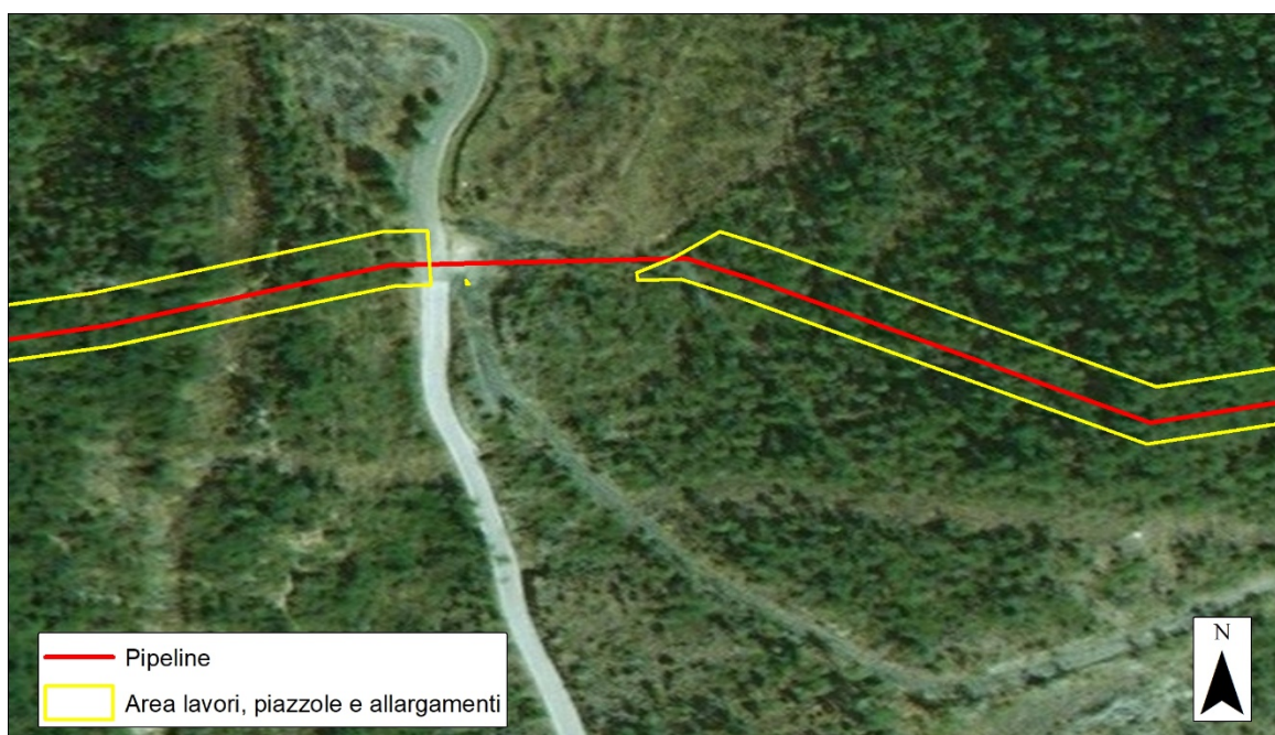
Fig. 2/B: Ortofoto (Imagery word) con sovrapposizione dell'area di passaggio del gasdotto per la stima delle piante arboree intercettate
