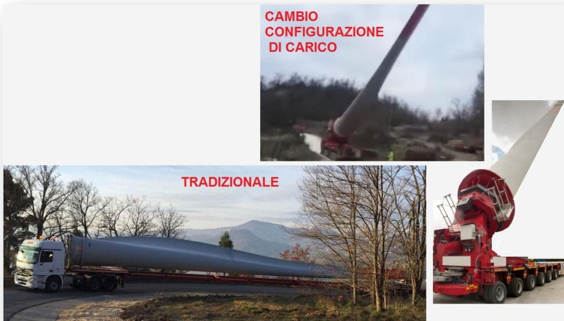
Figura 28 – esempi di trasporto tradizionale e soluzione con cambio della configurazione di carico durante il percorso
