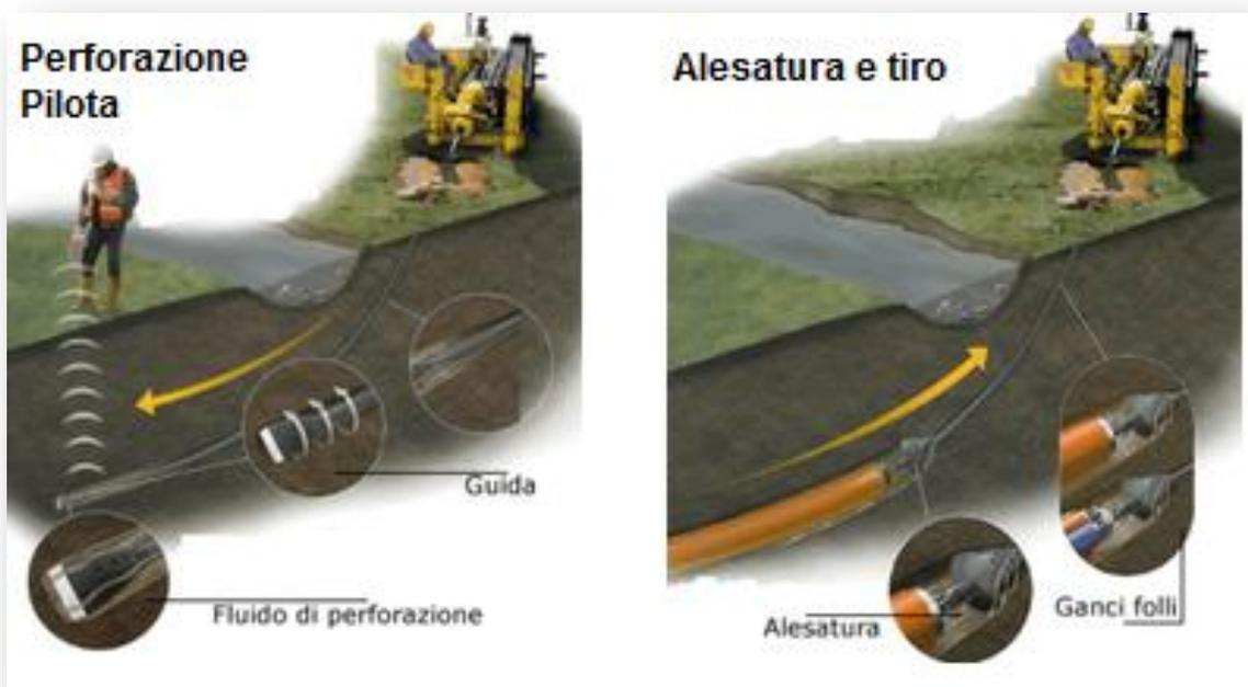
Figura 39 - tecnologia di trivellazione orizzontale controllata (TOC)
