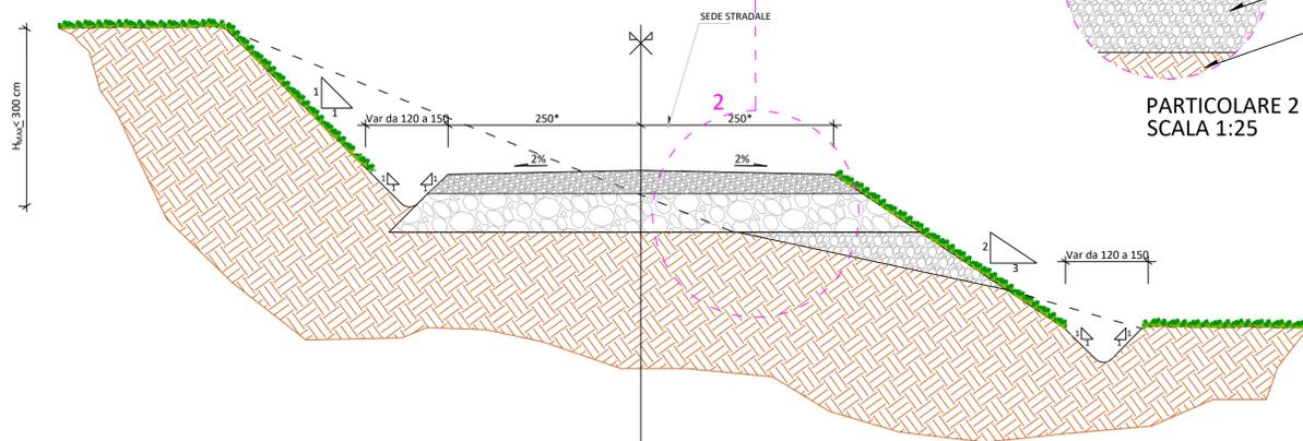
SEZIONE TIPO - STRADA DI NUOVA REALIZZAZIONE IN MEZZACOSTA
