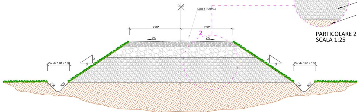
SEZIONE TIPO - STRADA DI NUOVA REALIZZAZIONE IN RILEVATO
