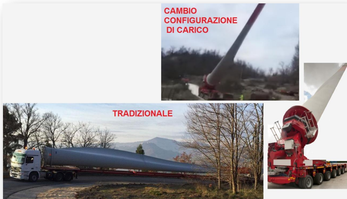
Figura 10 – Esempi di trasporto tradizionale e soluzione con cambio della configurazione di carico durante il percorso
