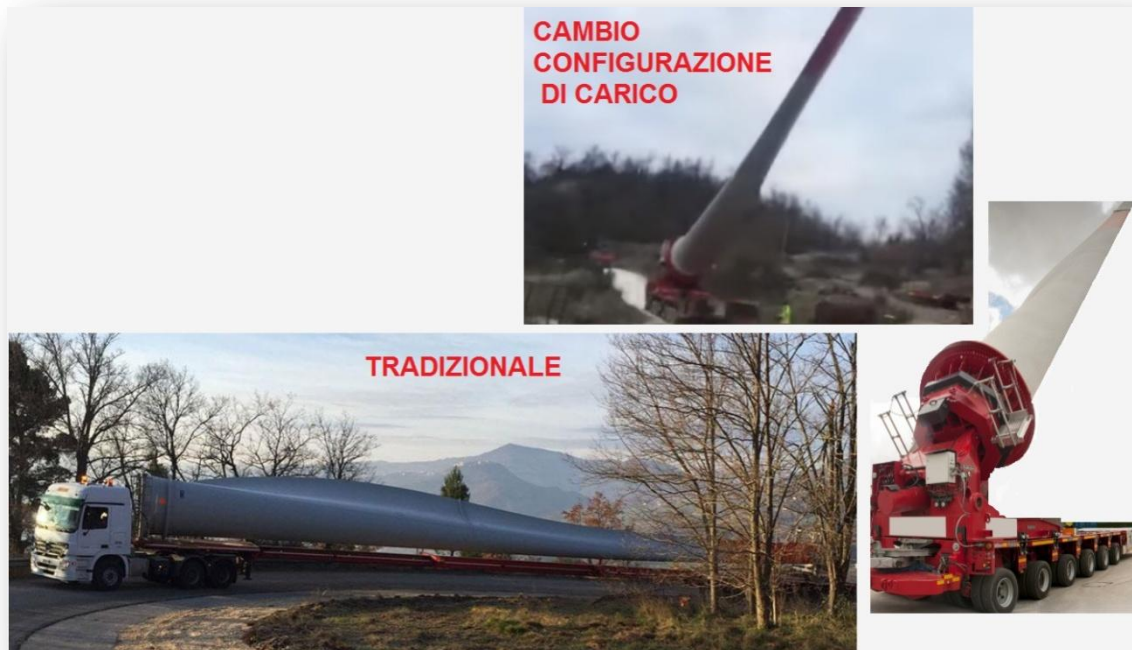
Figura 72 – Esempi di trasporto tradizionale e soluzione con cambio della configurazione di carico durante il percorso
