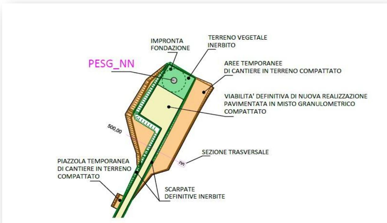
Figura 30 : schema rappresentativo della piazzola tipo
