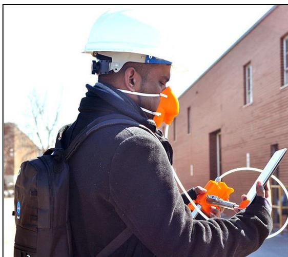
Figura 5.1.2.1.1-1 Valutatore con olfattometro portatile Scentroid SM100.
