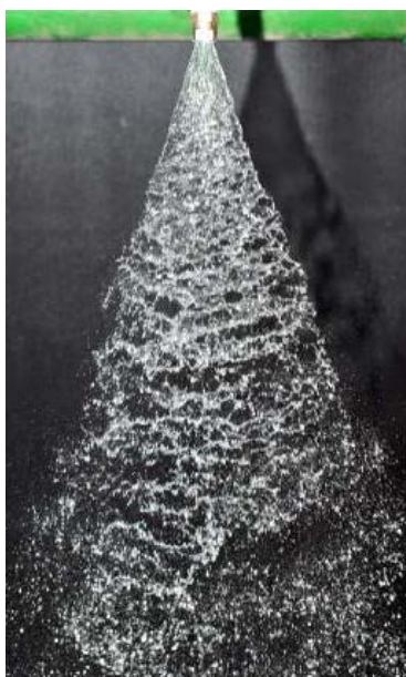
Figura 3.8: Esempio di ugello erogatore a lama d'acqua
