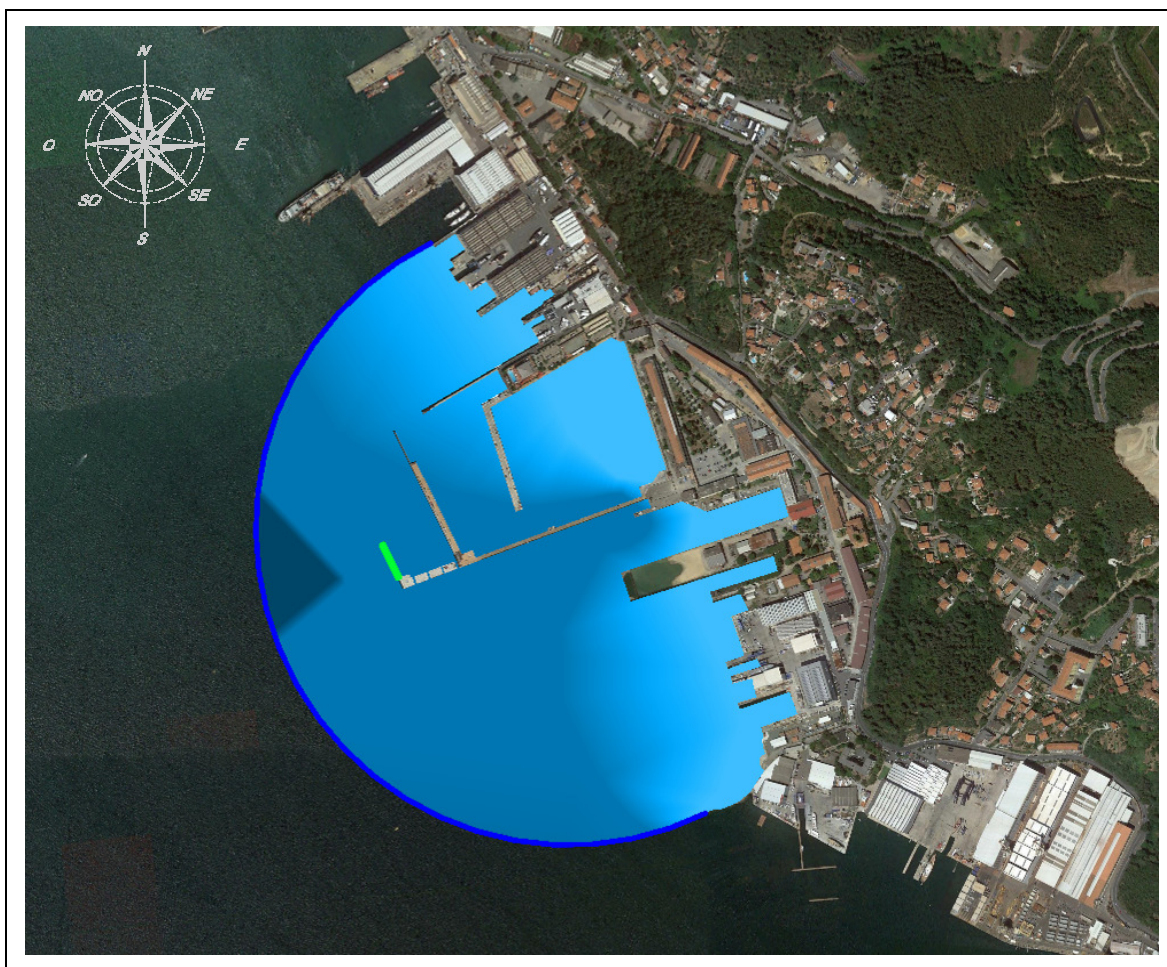
Fig. 7.2 – Dominio di calcolo impiegato nello studio della penetrazione del moto ondoso (fase 1)
