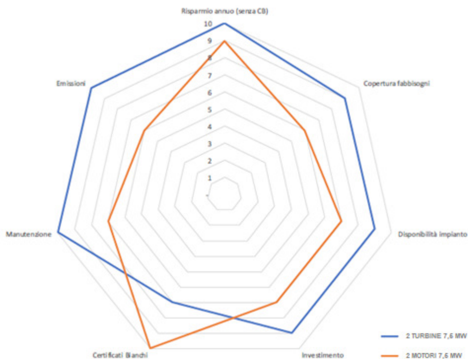
Fig. 2.6.2. – Risultati confronto tra soluzione turbine a gas e motori alternativi – All. 2.3.
