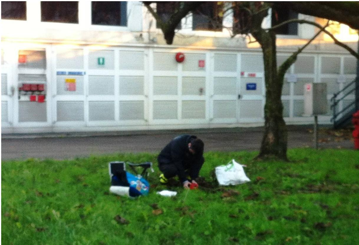
*Figura 4. Esecuzione della prospezione di sismica passiva TR1 con tromografo digitale.*
