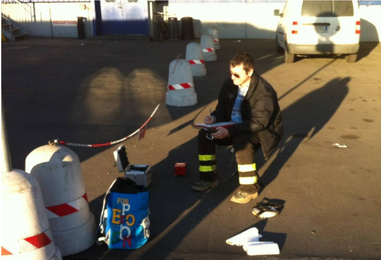
*Figura 5. Esecuzione della prospezione di sismica passiva TR2 con tromografo digitale.*
