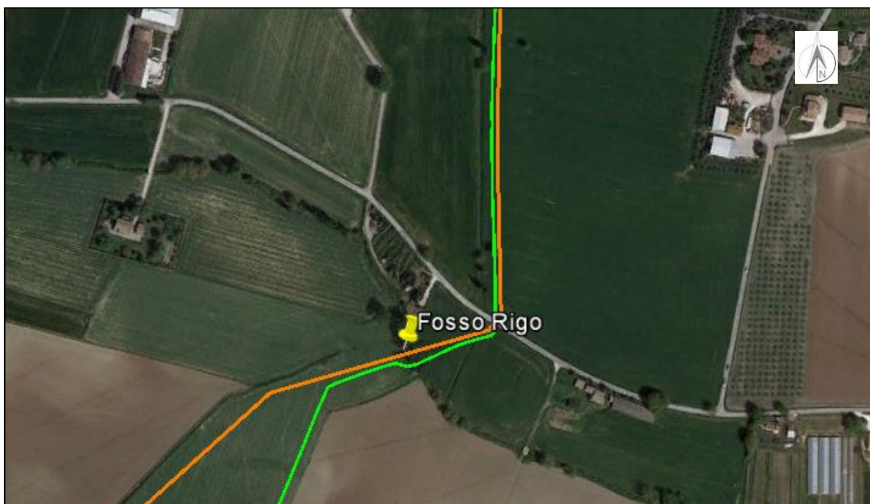
Figura 3.4.5/A: Attraversamento Fosso Rigo linea arancione: condotta in progetto linea verde: condotta in dismissione
