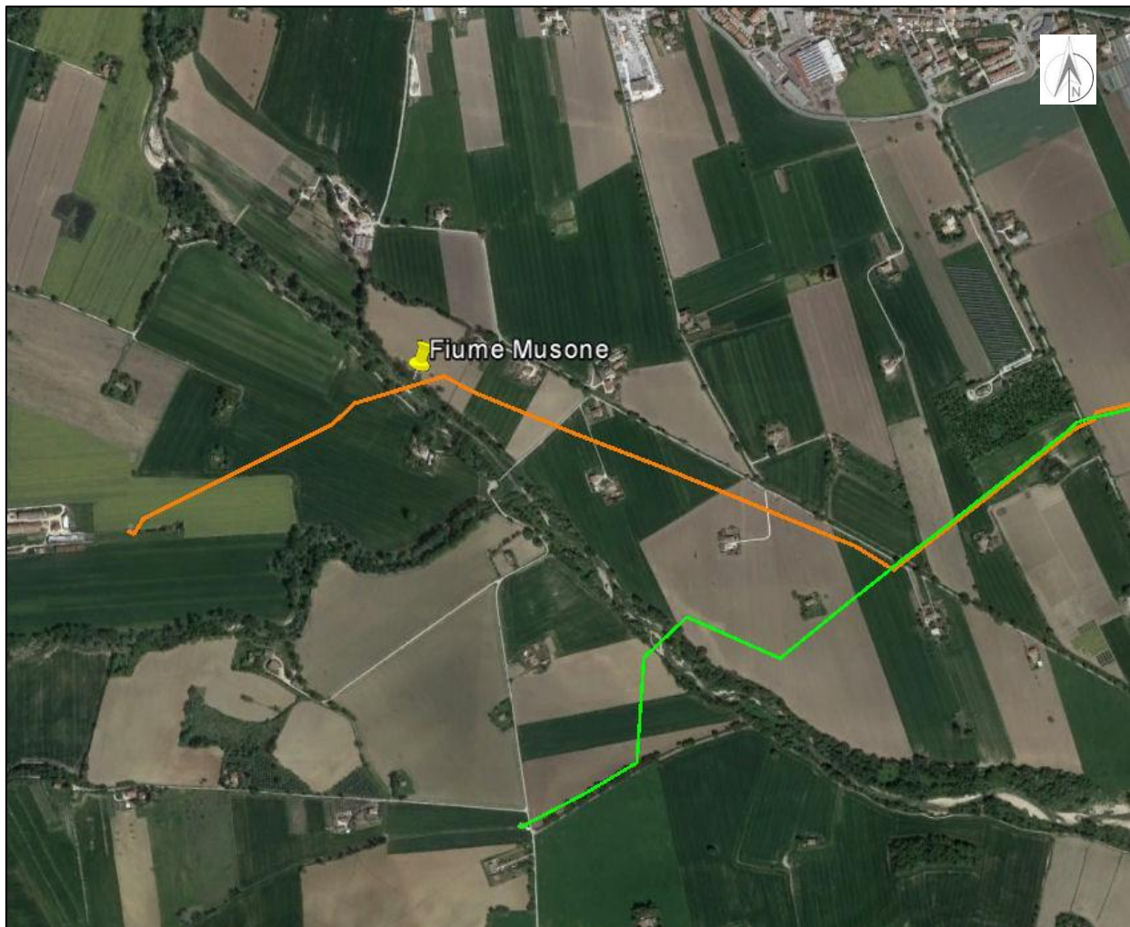
Figura 3.4.4/A: Attraversamento Fiume Musone linea arancione: condotta in progetto linea verde: condotta in dismissione
