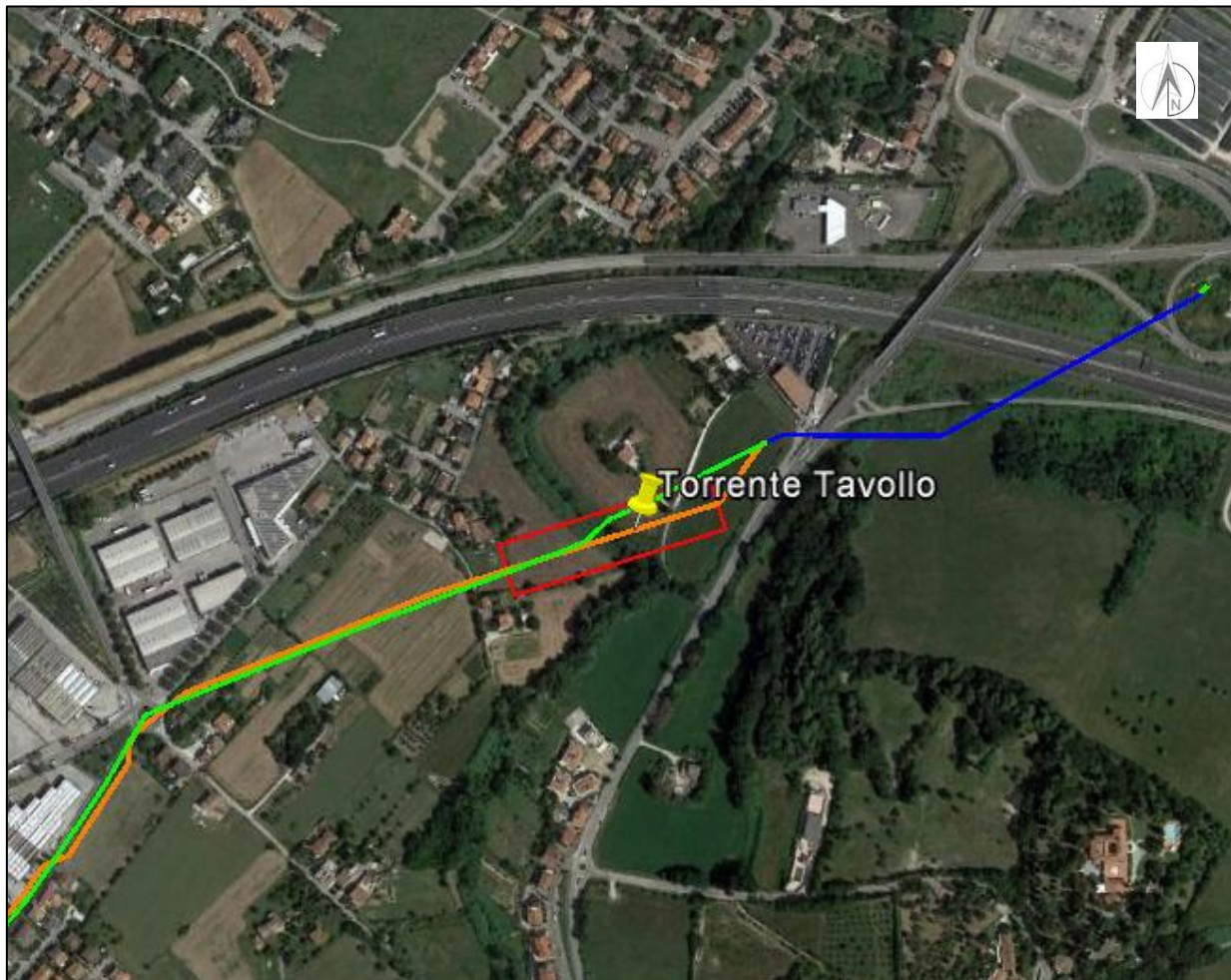
Figura 3.4.3/A: Attraversamento Torrente Tavollo linea arancione: condotta in progetto linea verde: condotta in dismissione linea blu: condotta esistente (da mantenere) rettangolo rosso: trenchless
