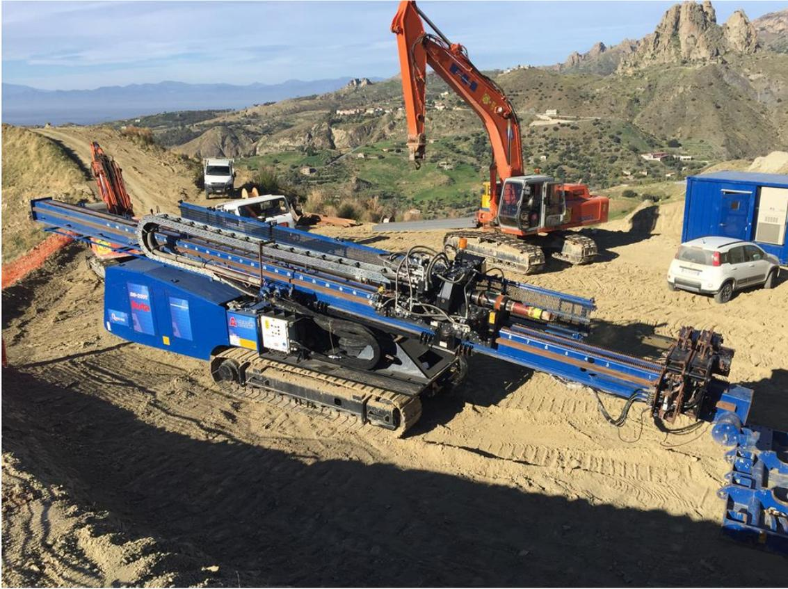
**Fig. 9.2/B:** Rig utilizzato per esecuzione di T.O.C.
