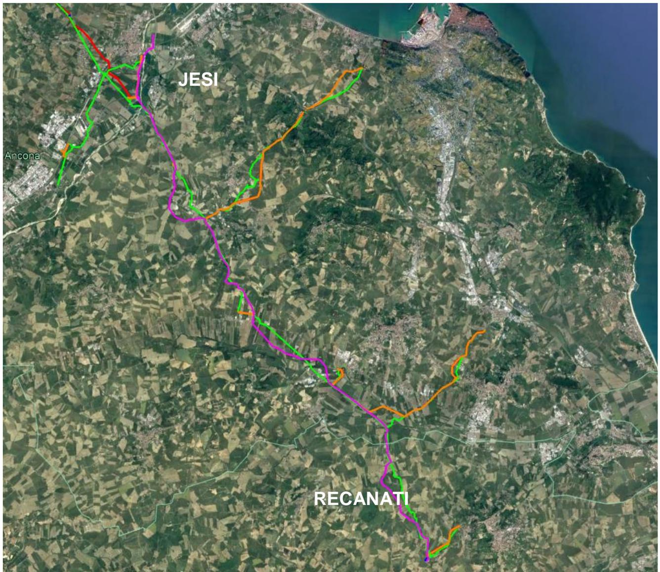
**Fig. 16/A: Sviluppo tracciati del progetto in esame e del Met. Falconara – Recanati, tratto Jesi – Recanati DN 1050 (42”)**
