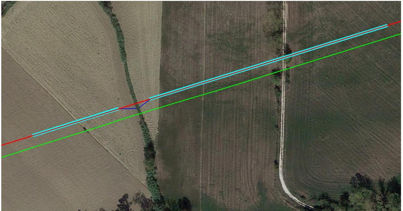
**Fig. 15.4/D:** “Met. Ravenna – Chieti tratto Ravenna – Jesi DN 650 (26”)” - tratto da km 110,705 a km 110,960 - In celeste l’ubicazione del drenaggio, in blu traccia dei tubi di scarico.
