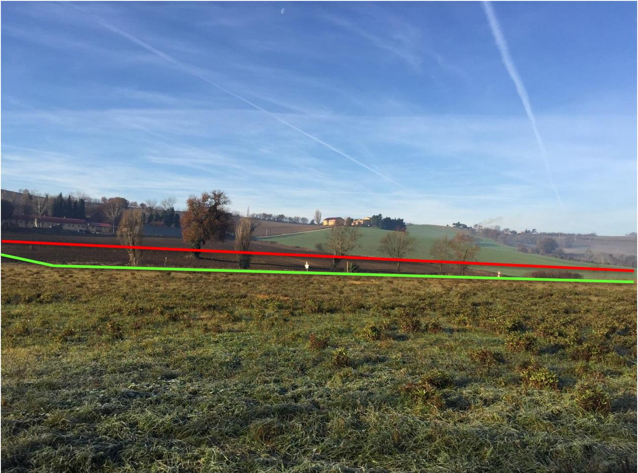
**Fig. 18/B:** Interferenza I.F.F.I. n. 11; in rosso è evidenziata la traccia di posa del metanodotto in progetto, mentre in verde è segnalata la condotta in esercizio, da dismettere.
