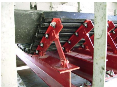
Sistema a bassa frizione per l'assorbimento degli urti dovuti al carico
