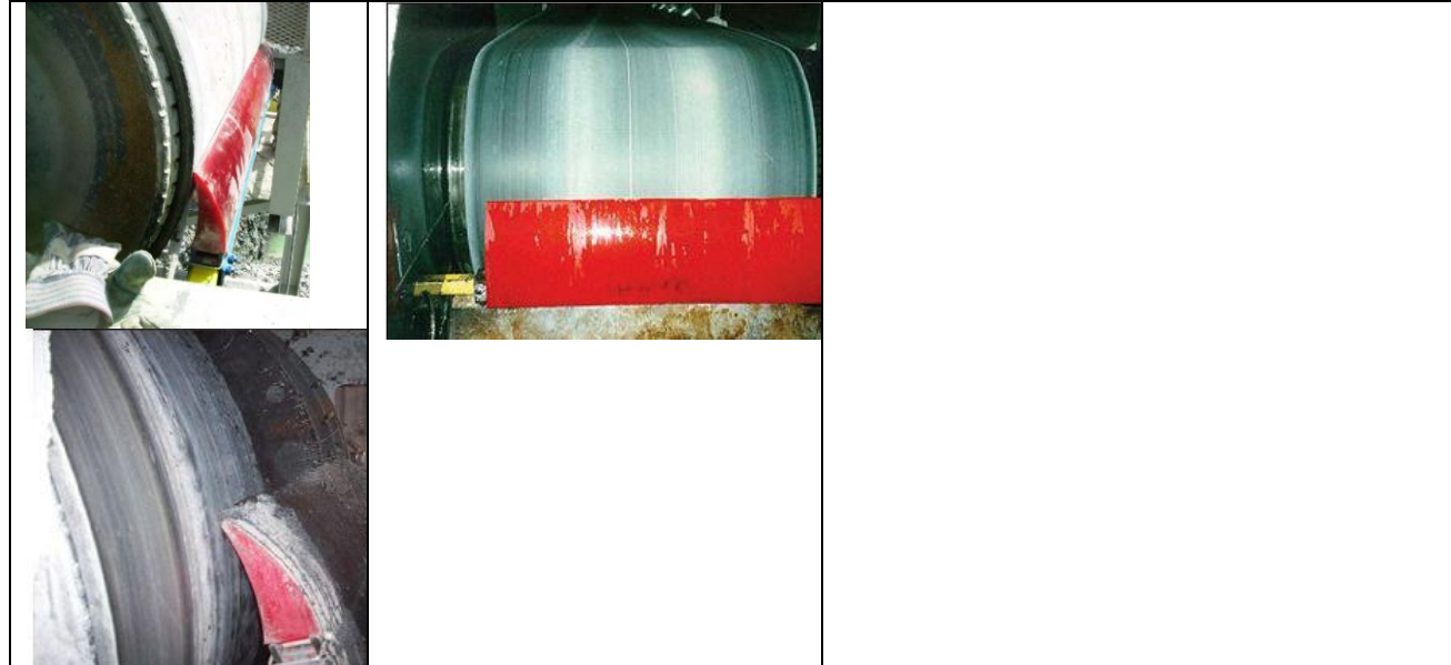
a: raschiatore primario alla puleggia di coda
