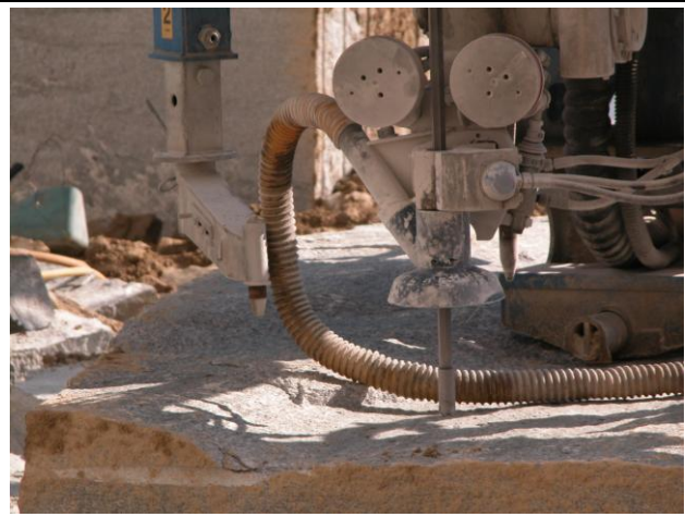
cappa aspirante connessa all'asta di perforazione e calabile a bocca foro per una perforatrice idraulica a spurgo detrito pneumatico
