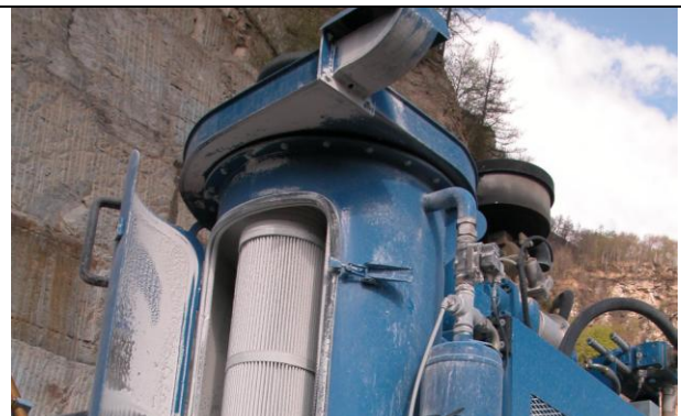
cappa aspirante calata a bocca foro durante la perforazione
