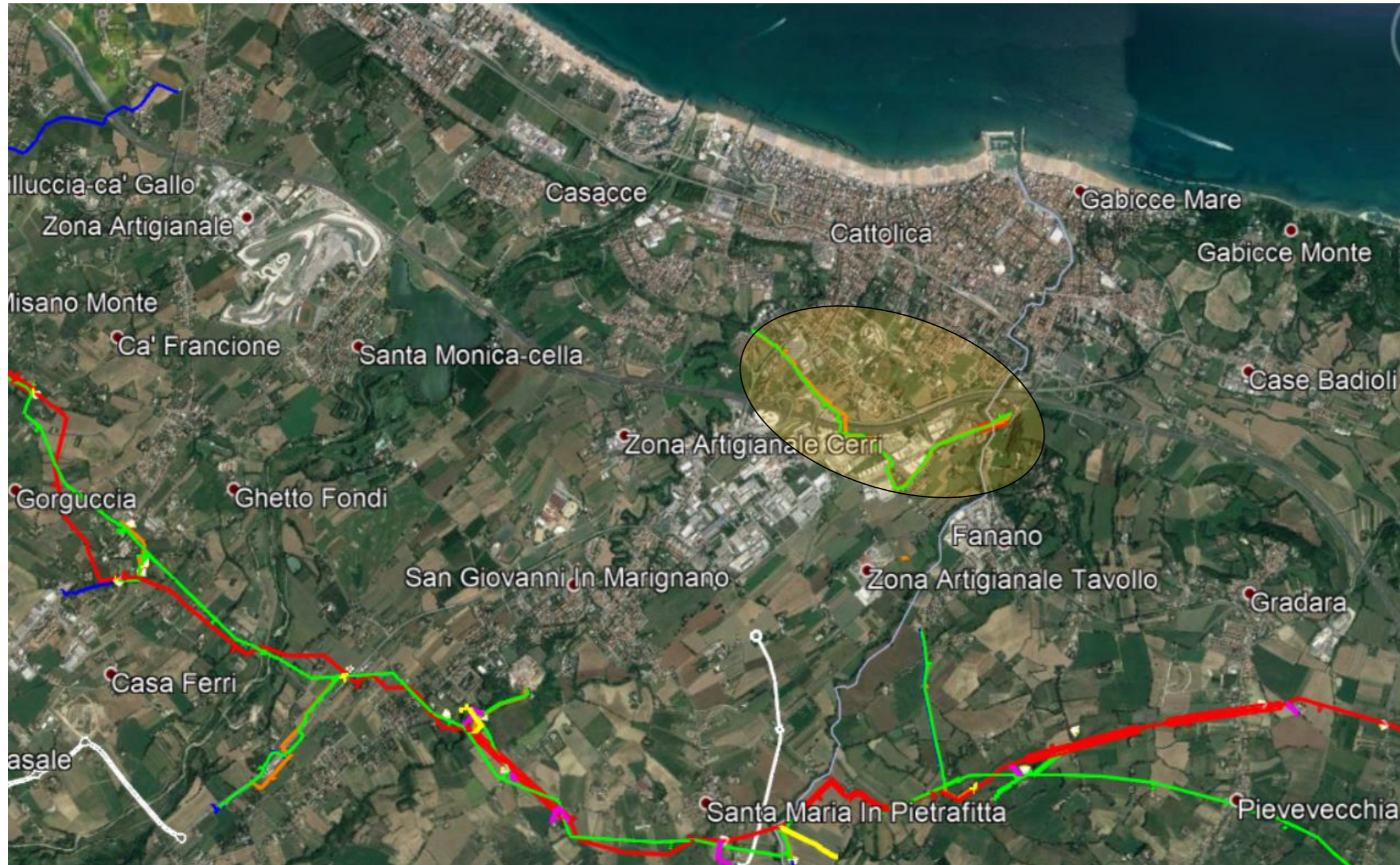
Figura 4.5 Allacciamento per Cattolica: in verde le linee in rimozione, in arancio i nuovi allacciamenti
