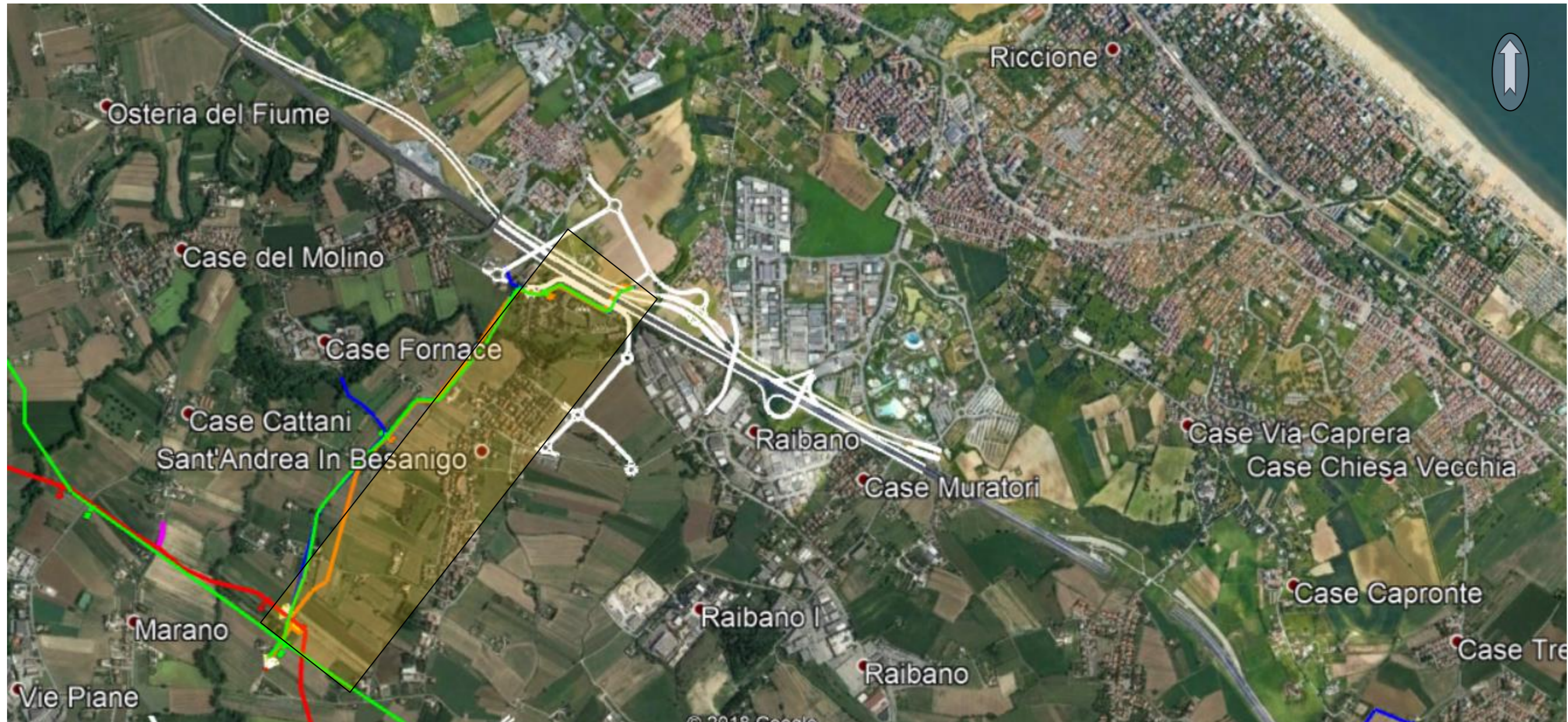
Figura 4.3/A: Allacciamento - rifacimento derivazione per Riccione su orto foto: in arancio la nuova linea in progetto, in verde la linea in rimozione
