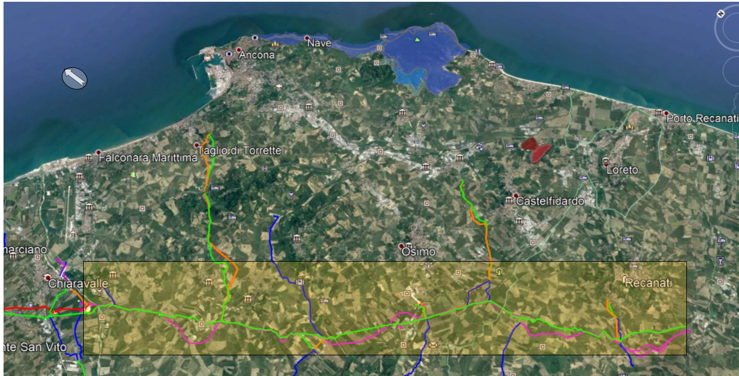
Figura 3.7/A: Tratto 9, Territorio indagato. In rosso il tracciato in progetto e in verde quello in rimozione (Google Earth) 2018. In arancio i tracciati degli allacciamenti. Le aree colorate corrispondono a SIC /ZPS della rete Locale di Natura 2000
