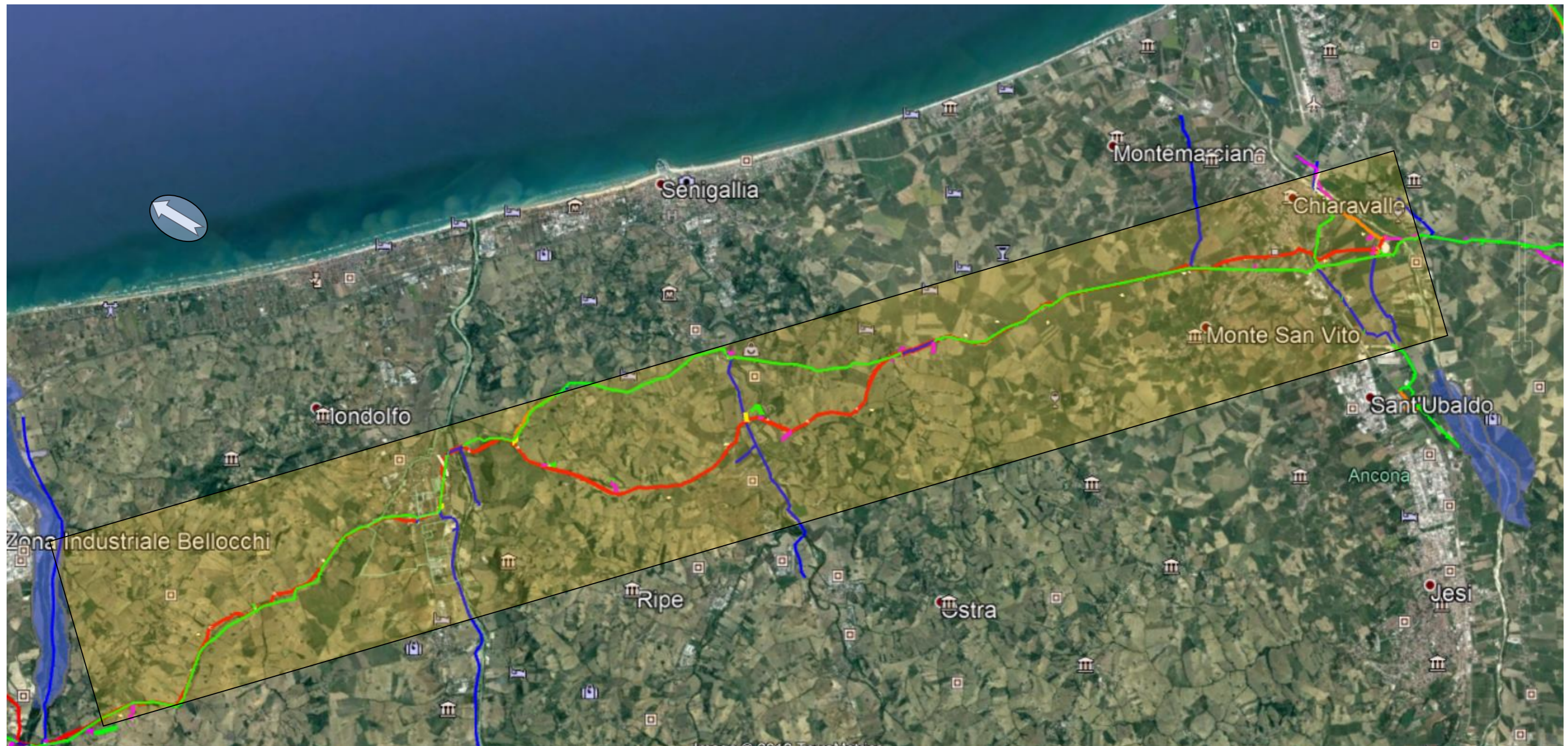
Figura 3.6/A: Tratto 6, Territorio indagato. In rosso il tracciato in progetto e in verde quello in rimozione (Google Earth) 2018. Le aree irregolari blu rappresentano Aree SIC/ZPS della rete locale di Natura 2000
