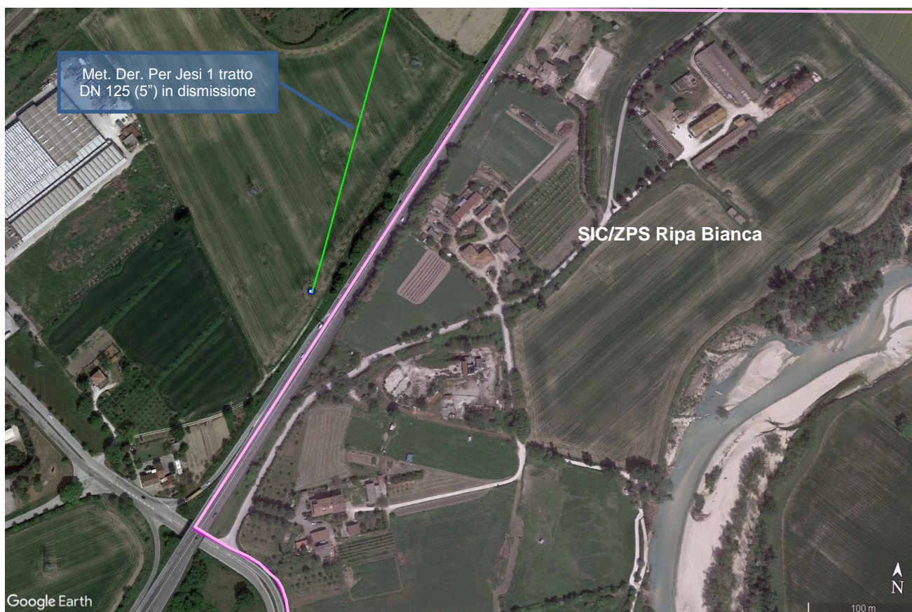
Fig. 4.7/A: Dismissione del “Met. Der per Jesi 1 tratto DN 125 (5”)” in prossimità del limite nord-occidentale del SIC-ZPS “Ripa Bianca”
