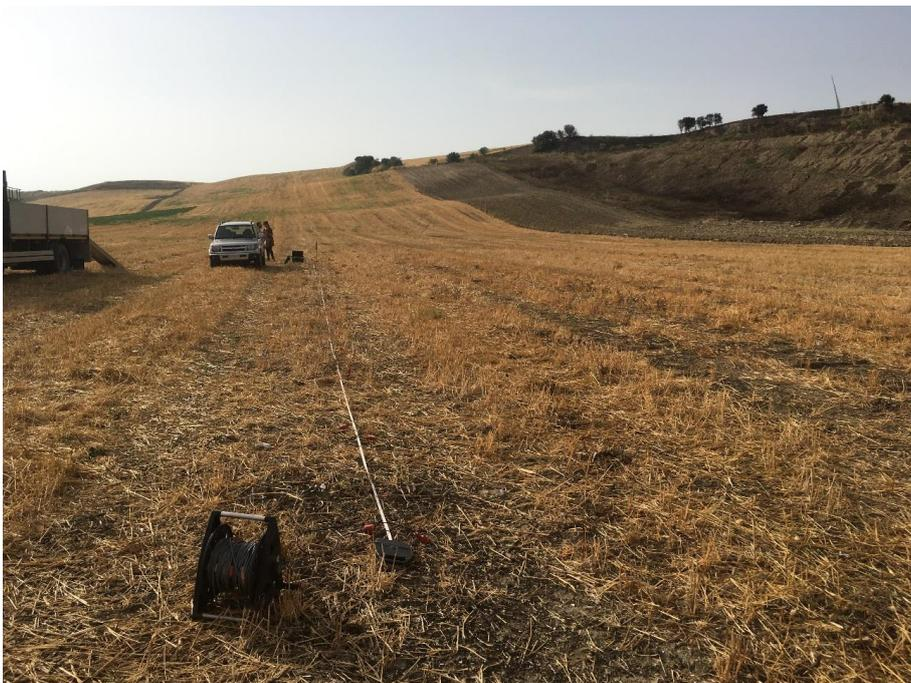
**Fig. 3.A - Fasi di acquisizione della prospezione sismica MASW/Re.Mi.**
