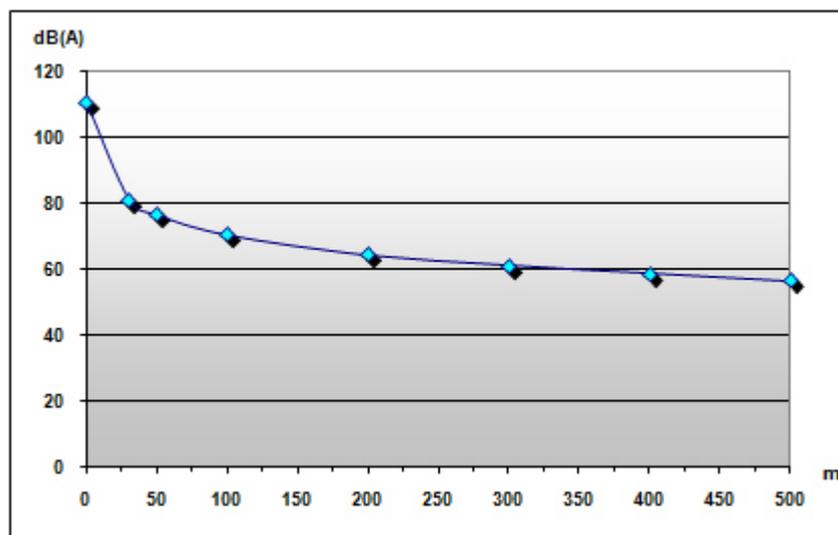
Figura 3.27 - Decadimento, per divergenza geometrica, dell'energia sonora con la distanza per squadra-tipo di lavoro
