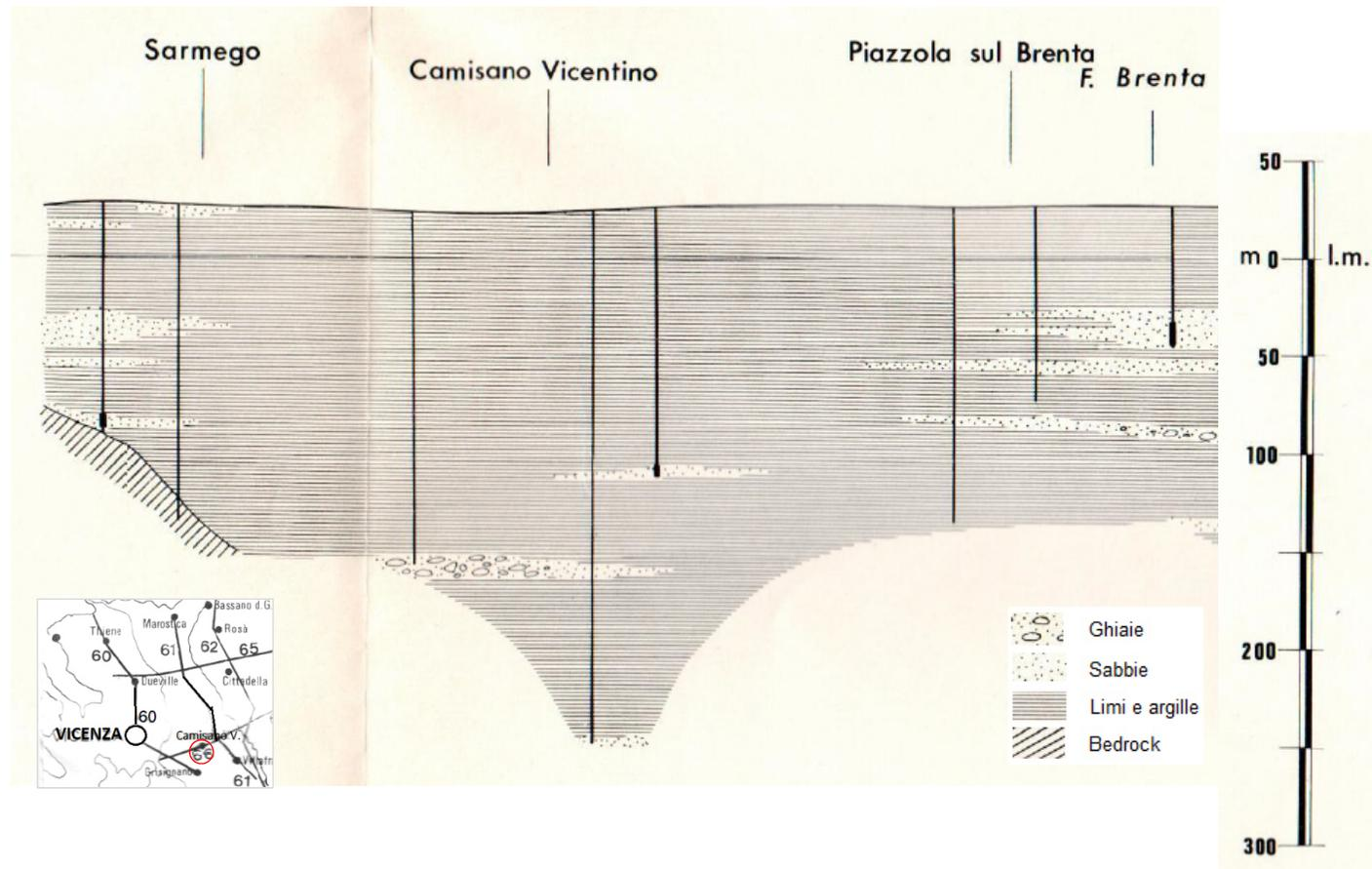
Figura 3.22 – Profilo W-E (n.66) attraverso il settore di media pianura [fonte: IRSA, 1978]
