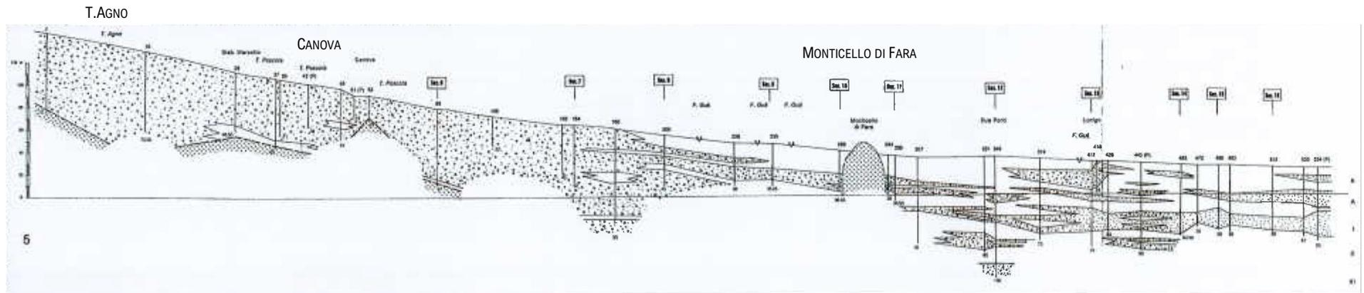
Figura 3.23 - Sezione stratigrafica longitudinale tra valle dell'Agno e pianura antistante. La comparsa dei depositi coesivi (in bianco) si verifica in corrispondenza dello sbocco in pianura della valle [fonte: Antonelli et al., 1993]
