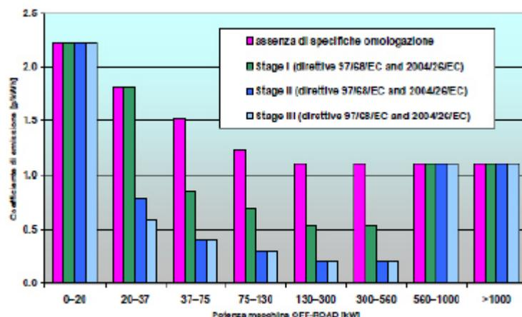
Figura 3.9 - Coefficienti di emissione PM10 per veicoli off-road
