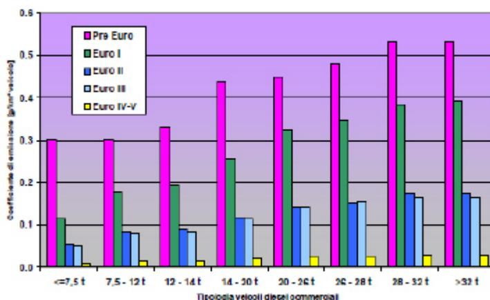
Figura 3.8 - Coefficienti di emissione PM10 per veicoli diesel commerciali pesanti
