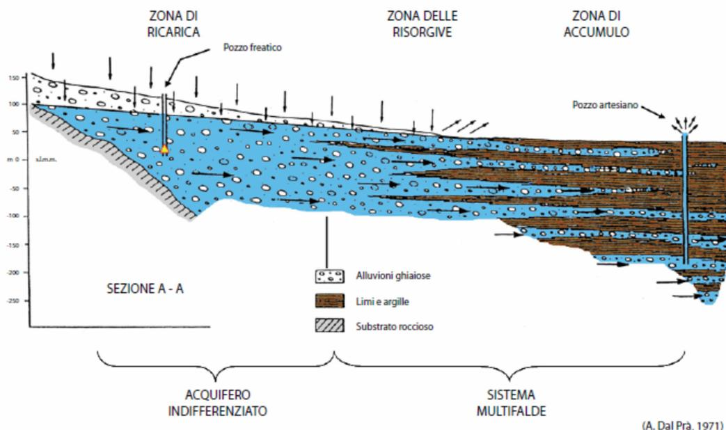
Figura 3.15 - Schema idrogeologico dell'alta e media pianura veneta [fonte: ARPAV, 2008]
