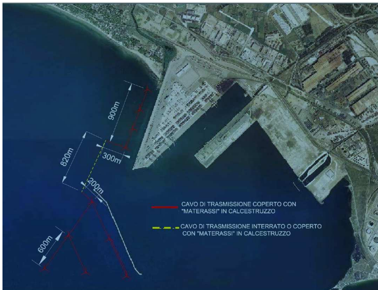
Figura 1 - Percorso Elettrodotto sottomarino/Materassi
