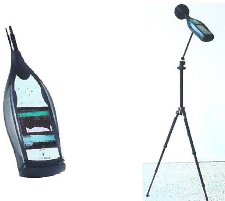
Figg. 3 e 4 Fonometro utilizzato per i rilievi fissato su treppiede e provvisto di cuffia antivento
