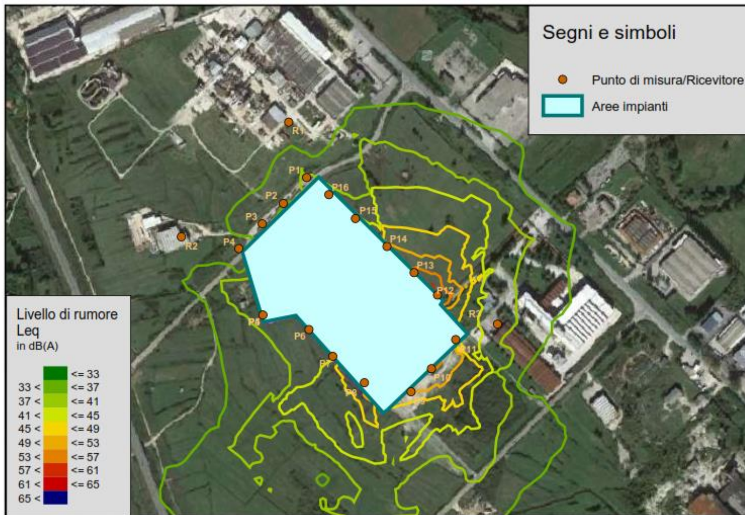
Figura 6- Curve isofoniche ottenute all'esterno dello stabilimento e riconducibili alle sorgenti autorizzate ed al nuovo trigeneratore
