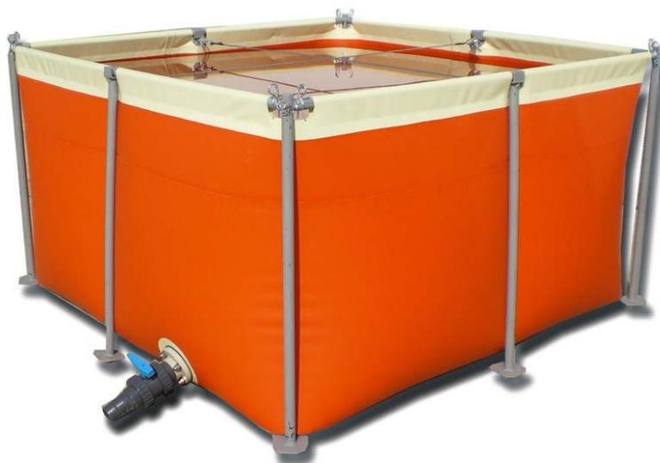
La tipologia delle vasche per acqua è uguale o analoga al modello di serbatoio flessibile tipo T, prodotto dalla SO.CA.P. di Lissone (Monza-Brianza), con pianta rettangolare o quadrata, costituito da un contenitore, in tessuto poliestere extraforte rivestito con plastomeri, sorretto da un telaio metallico di facile assemblaggio.
